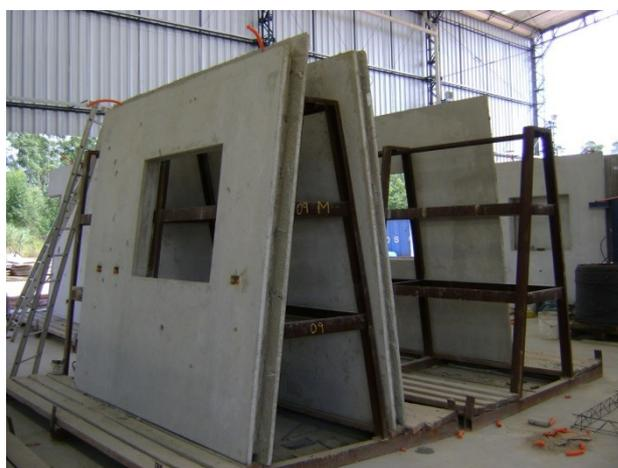
Figura 18 – Estocagem dos painéis
