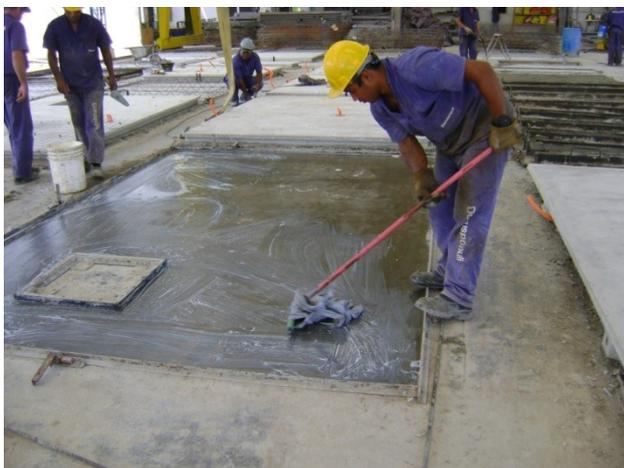
Figura 11 – Aplicação de desmoldante na pista de concretagem
