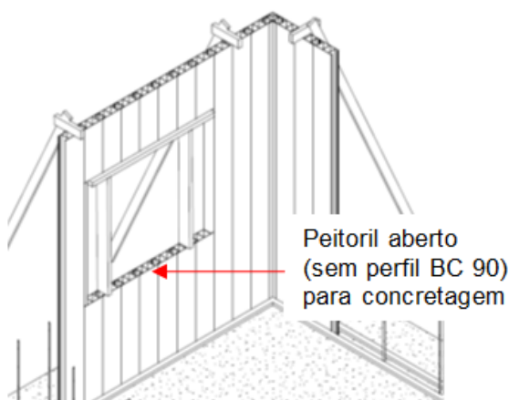
Figura 66 – Ilustração do escoramento dos vãos de janelas com peitoril aberto para concretagem.
