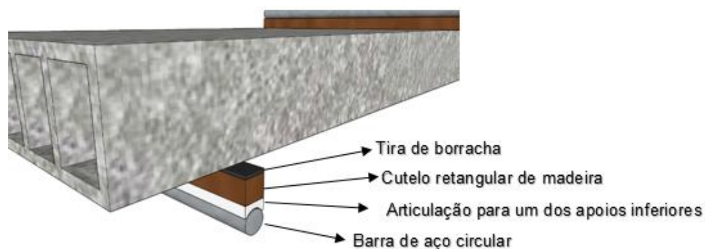
Figura 12– Detalhe do apoio para o ensaio de flexão
