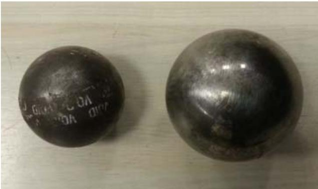
Figura 7 – Esferas metálicas de 0,5 kg (esquerda) e 1 kg (direita)
