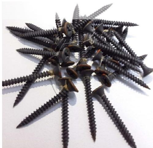
**Figura 15 – Parafusos submetidos ao ensaio de resistência à corrosão**
