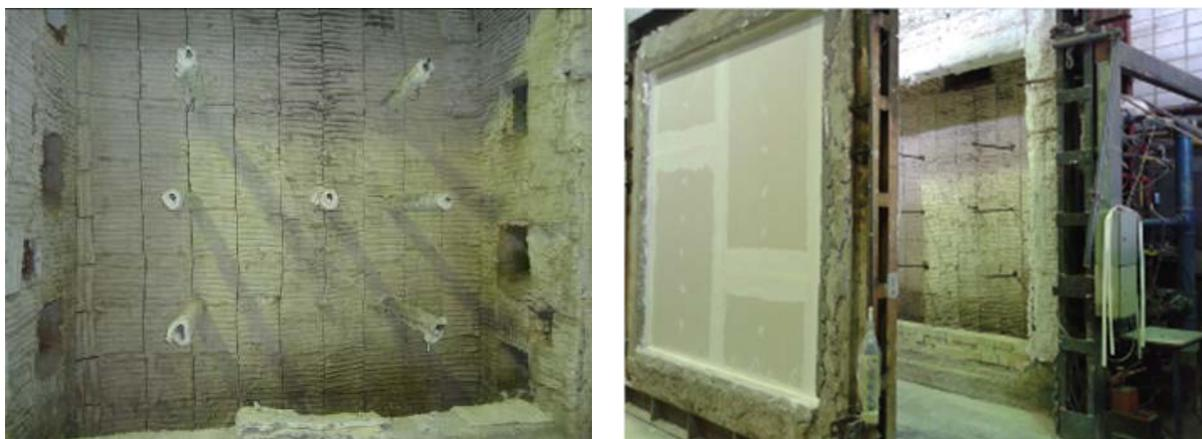
Figura 11 – Ensaio de resistência ao fogo de sistema em chapas de gesso para *drywall*
