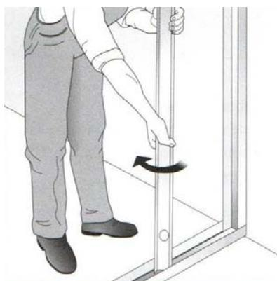
**Figura 23 – Encaixe dos montantes na guia (sem escala)**
