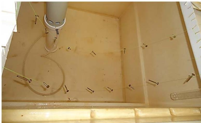
**Figura 14 – Parafusos posicionados na câmara de névoa salina neutra para a realização do ensaio**
