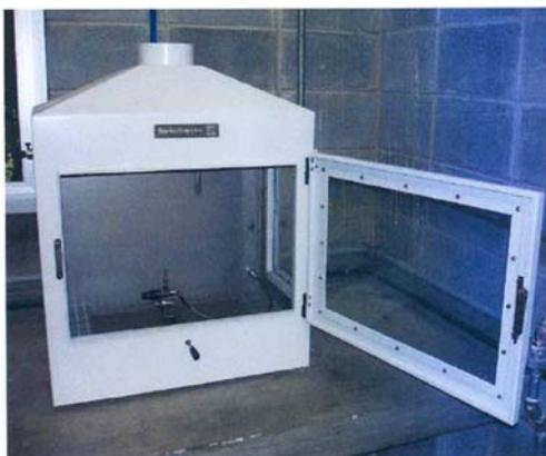
Figura 10 – Câmara de ensaio de ignitabilidade
