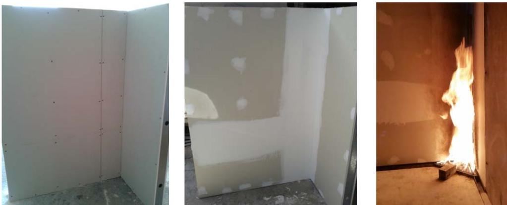
Figura 9 – Detalhe do corpo de prova e do ensaio SBI em andamento
