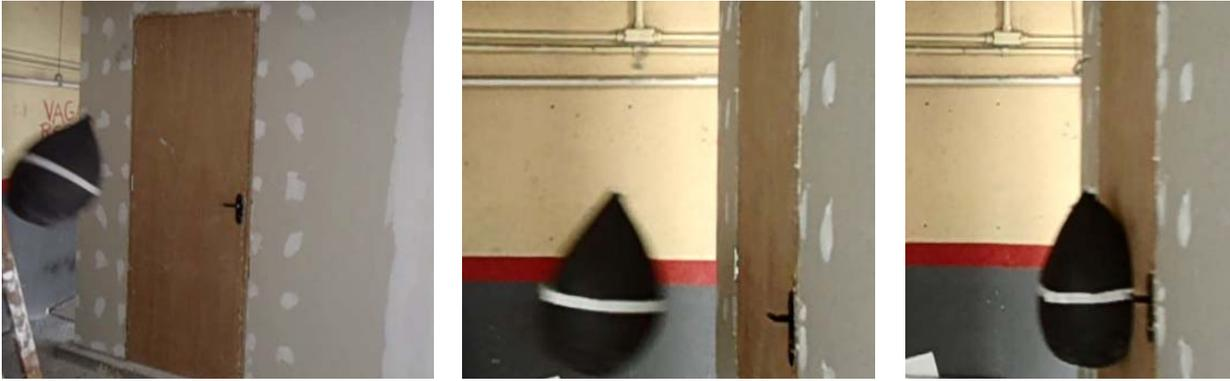
Figura 6 – Ensaio de impacto de corpo mole no centro geométrico da porta
