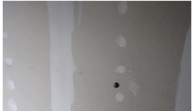
Figura 8 – Ensaio de impacto de corpo duro no SVVI em *drywall*
