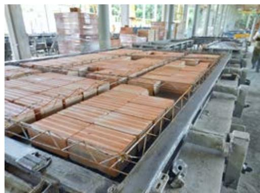
Figura 11 – Detalhe dos blocos cerâmicos entre as armaduras.
