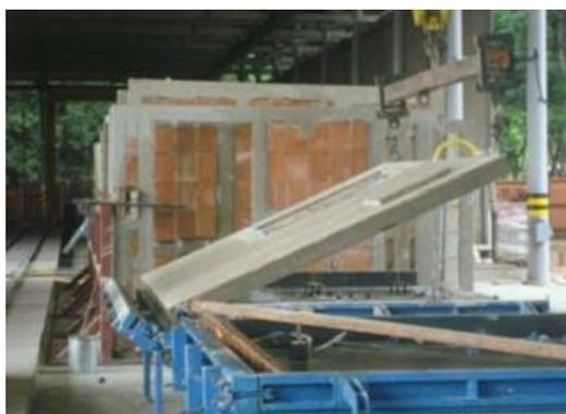
Figura 15 - Desenforma dos painéis.
