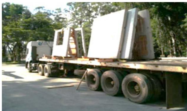
Figura 18 – Cavaletes para transporte dos painéis.
