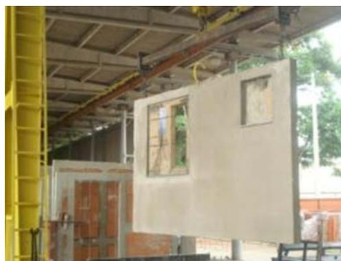
Figura 16 - Estocagem dos painéis para inspeção.
