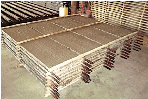
Figura 20 – Empilhamento das formas metálicas para processo de cura.
