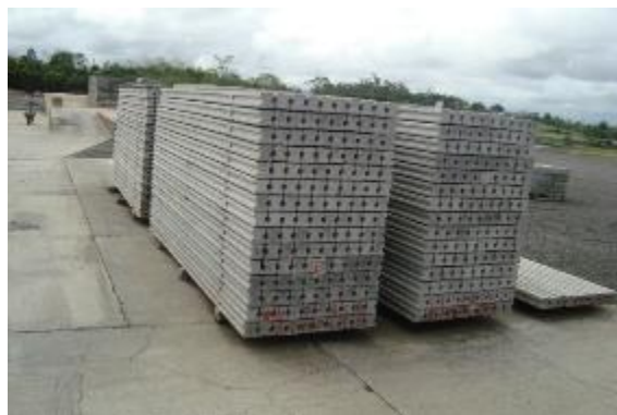
Figura 35 – Estocagem dos pilares no pátio da unidade fabril.
