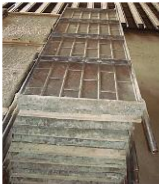
Figura 12 – Forma metálica destinada a produção de quatro painéis de vedação.
