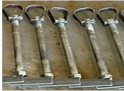
Figura 23 – Parafusos das formas metálicas.
