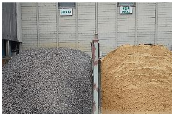
Figura 15 – Baias de estocagem dos agregados graúdos e miúdos.
