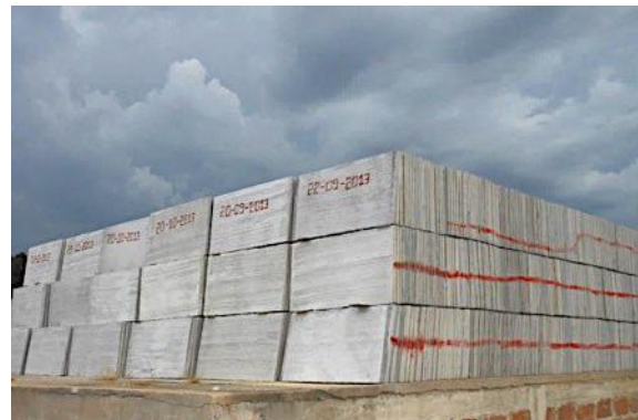
Figura 21 – Estocagem dos painéis de vedação no pátio da unidade fabril.
