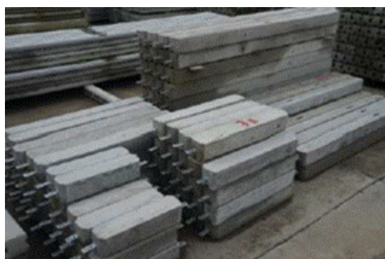
Figura 43 – Estocagem das vigas no pátio da unidade fabril.
