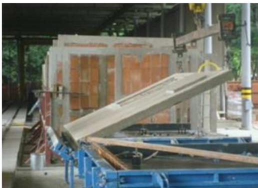
Figura 15 - Desenforma dos painéis
