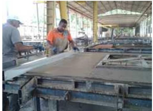
Figura 14 - Regularização com régua metálica
