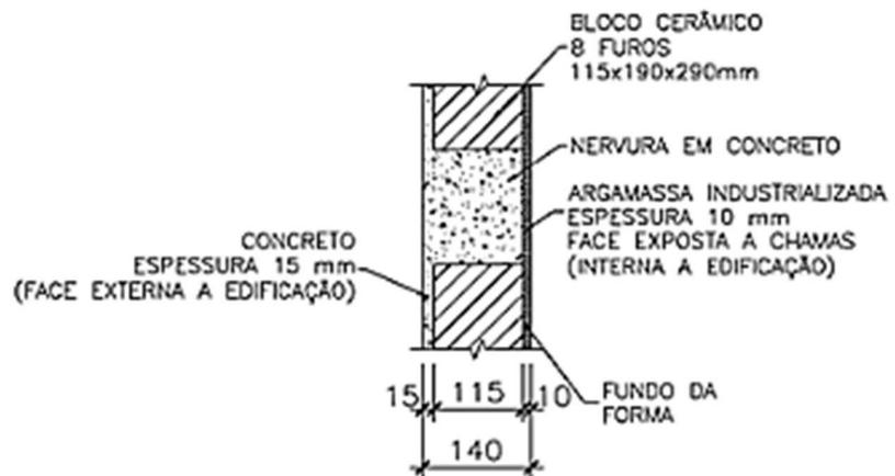
Figura 5 – Corte típico do painel das paredes de geminação e de divisa de áreas comuns (medidas em mm)
