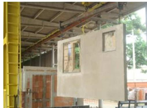
Figura 16 - Estocagem dos painéis para inspeção
