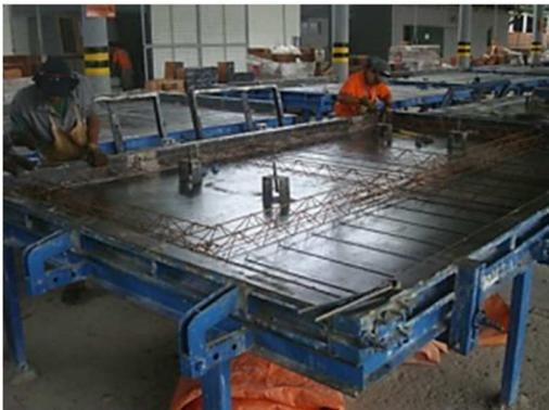
Figura 8 – Distribuição da armadura das nervuras
