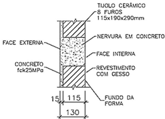
Figura 3 – Corte típico do painel das paredes externas
