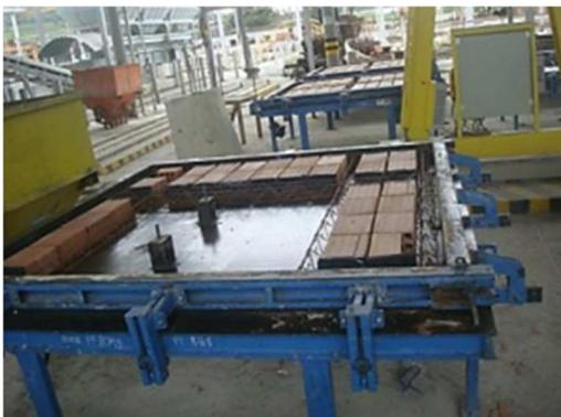
Figura 10 – Distribuição dos blocos cerâmicos
