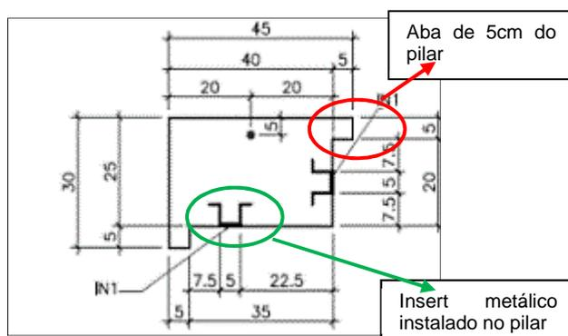
Figura 27 – Seção do pilar (detalhe da aba de anteparo dos painéis e insert de ligação embutido no pilar) (medidas em cm)
