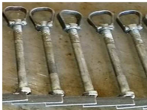
Figura 24 – Parafusos das formas metálicas.
