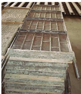
Figura 13 – Forma metálica destinada a produção de quatro painéis de vedação.
