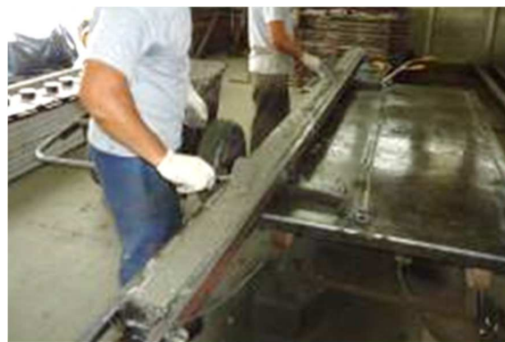
Figura 32 – Lançamento da segunda camada de concreto na forma metálica.
