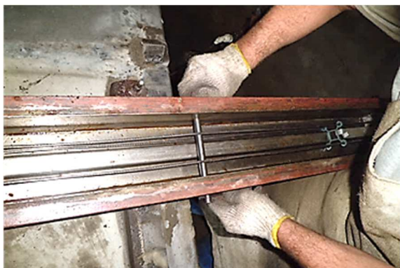
Figura 23 – Forma metálica para pilares pré-fabricados em concreto armado.
