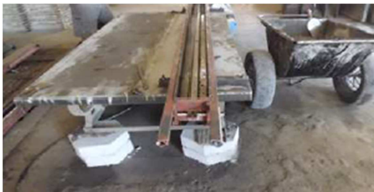
Figura 37 – Forma metálica para pilares pré-fabricados em concreto armado.
