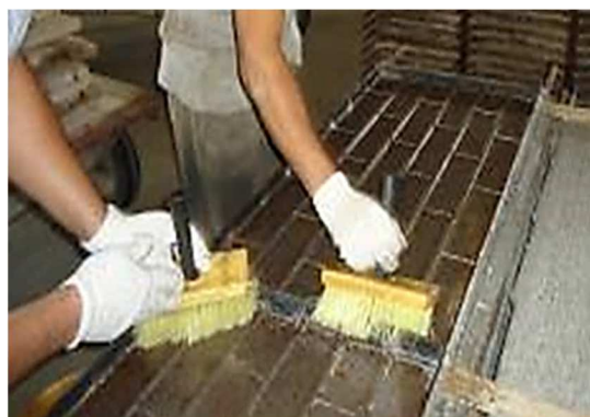
Figura 14 – Aplicação do desmoldante.
