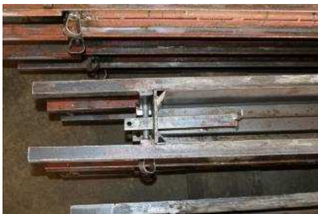
Figura 40 – Barras de aço CA-60 de Ø 5mm e chapa metálica.
