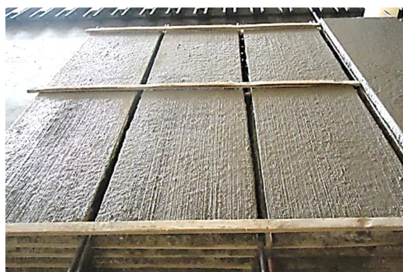
Figura 20 – Painéis com ranhuras.
