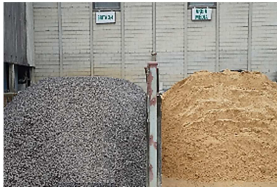
Figura 16 – Baías de estocagem dos agregados graúdos e miúdos.
