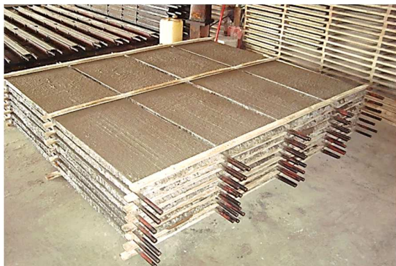
Figura 21 – Empilhamento das formas metálicas para processo de cura.
