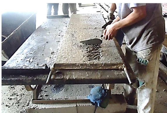
Figura 19 – Paineis de vedação após vibração da segunda camada de concreto.
