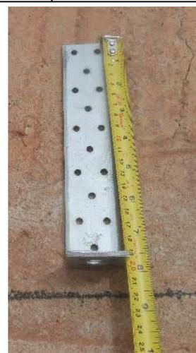
Figura 27 – Fixação do quadro estrutural de entrepiso na fundação.
