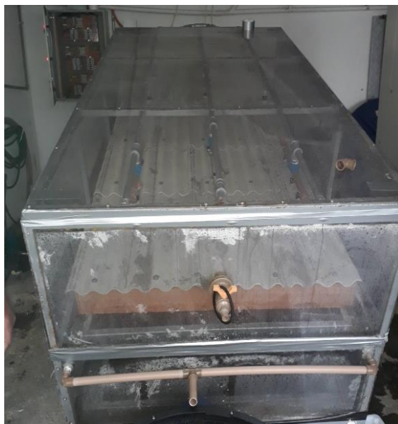
Figura 15 – Estanqueidade do sistema de cobertura – telhado submetido ao ensaio dentro da câmara de estanqueidade
