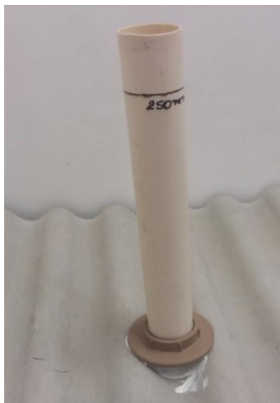
Figura 13 – Estanqueidade: Impermeabilidade – ilustração do ensaio
