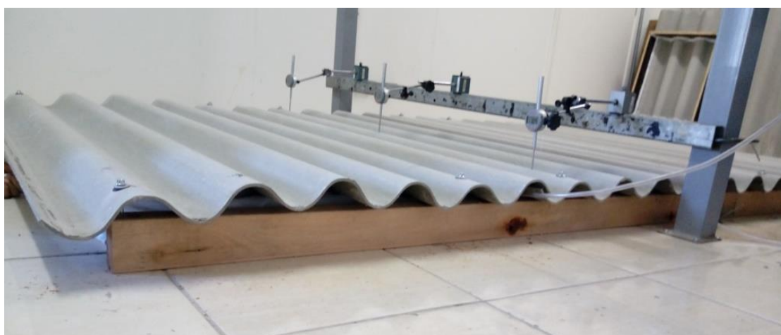
Figura 8 – Risco de arrancamento de componentes do sistema de cobertura sob ação do vento – telhado submetido ao ensaio, com relógios comparadores posicionados
