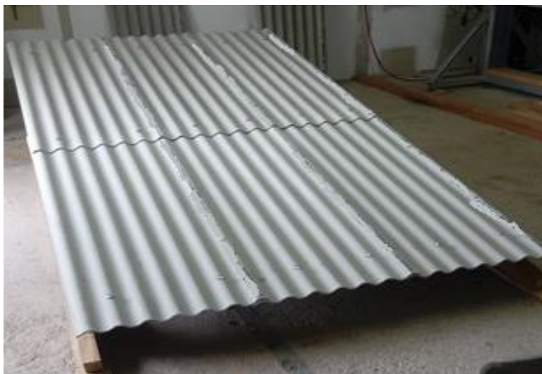
Figura 3 – Telhado constituído de telhas onduladas de fibrocimento sem amianto – tipo pequenas ondas (PO) de 4 mm de espessura
