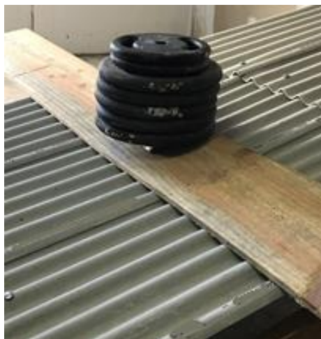
Figura 12 – Possibilidade de caminhamento de pessoas sobre o sistema de cobertura – telhado submetido ao ensaio
