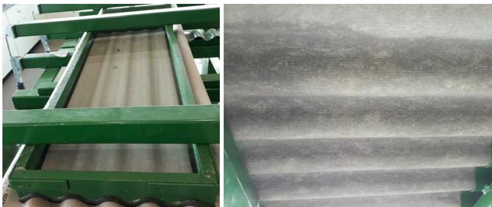
Figura 14 – Permeabilidade – telha submetida ao ensaio
