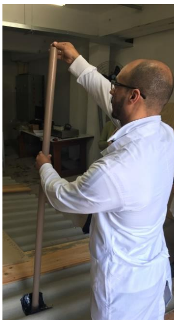
Figura 9 – Ação do granizo e outras cargas acidentais em telhados – telhado submetido ao ensaio
