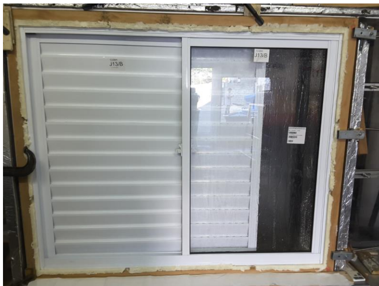
Figura 10 – Execução do ensaio de estanqueidade à água
