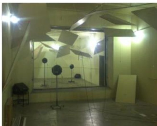
Figura 13 – Câmara de ensaio de isolamento sonora
