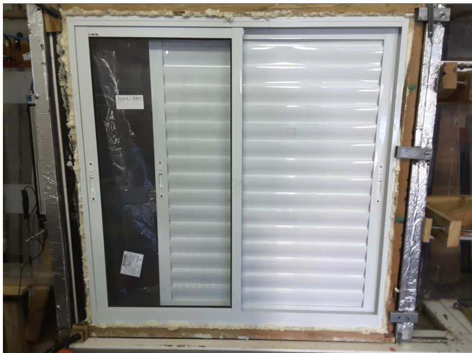
Figura 9 – Execução do ensaio de permeabilidade ao ar
