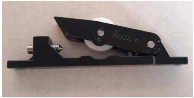
**Figura 23 – Roldanas submetidas ao ensaio de verificação da resistência à corrosão**
