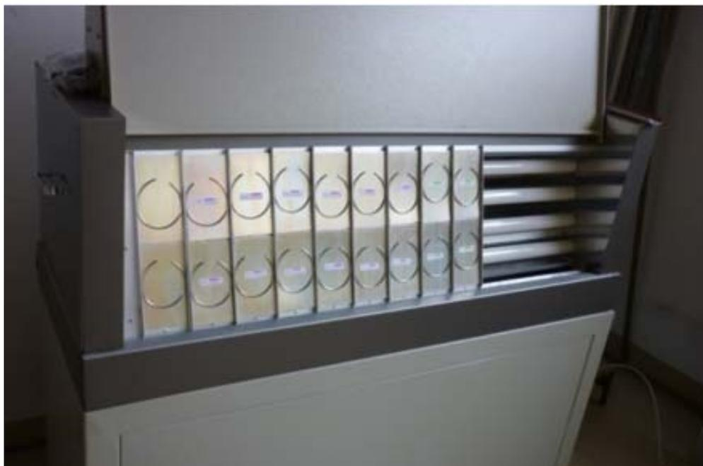
**Figura 19 – Câmara CUV para avaliação da durabilidade do composto de PVC**
