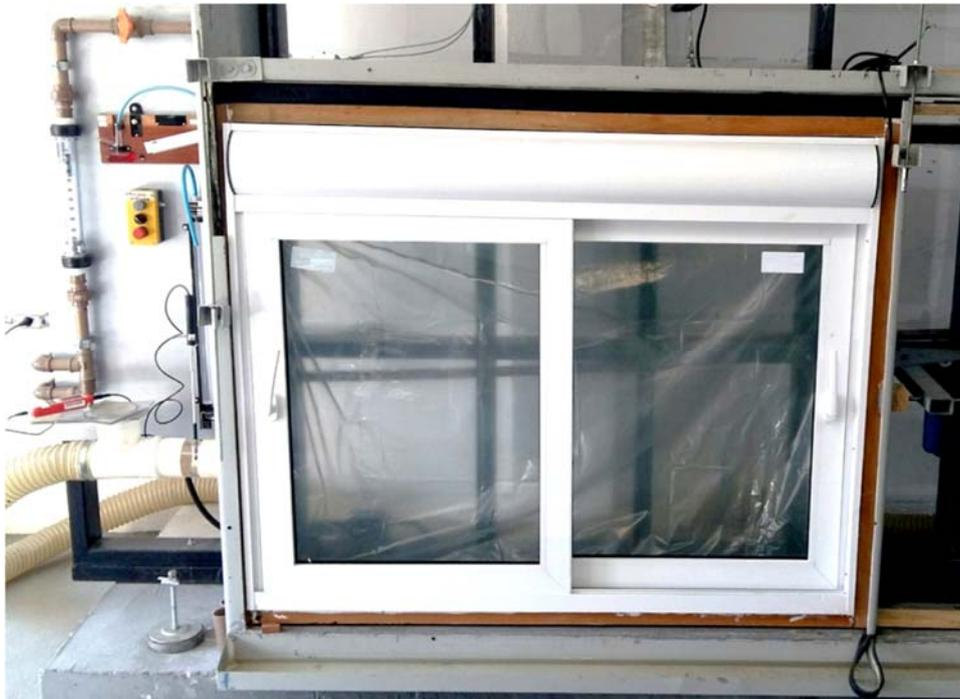
**Figura 11 – Execução do ensaio de permeabilidade ao ar**
