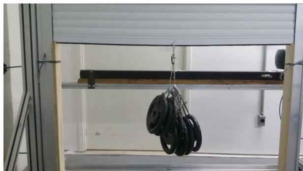
Figura 8 – Esquema do ensaio para esquadrias do tipo integrada – persiana de enrolar (esquerda) e execução do ensaio (direita)
