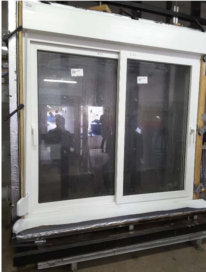
**Figura 12 – Execução do ensaio de estanqueidade à água**
