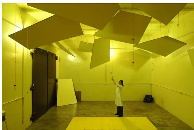
**Figura 15 – Câmara de ensaio de isolamento sonora**
