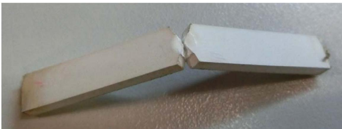
**Figura 22 – Corpo de prova submetido ao ensaio de verificação da resistência ao impacto Charpy após exposição em câmara CUV**
