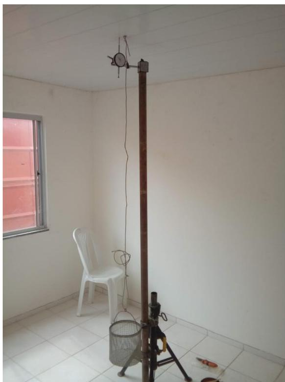
Figura 3 - Realização do ensaio de resistência de peças fixadas em forro de PVC rígido
