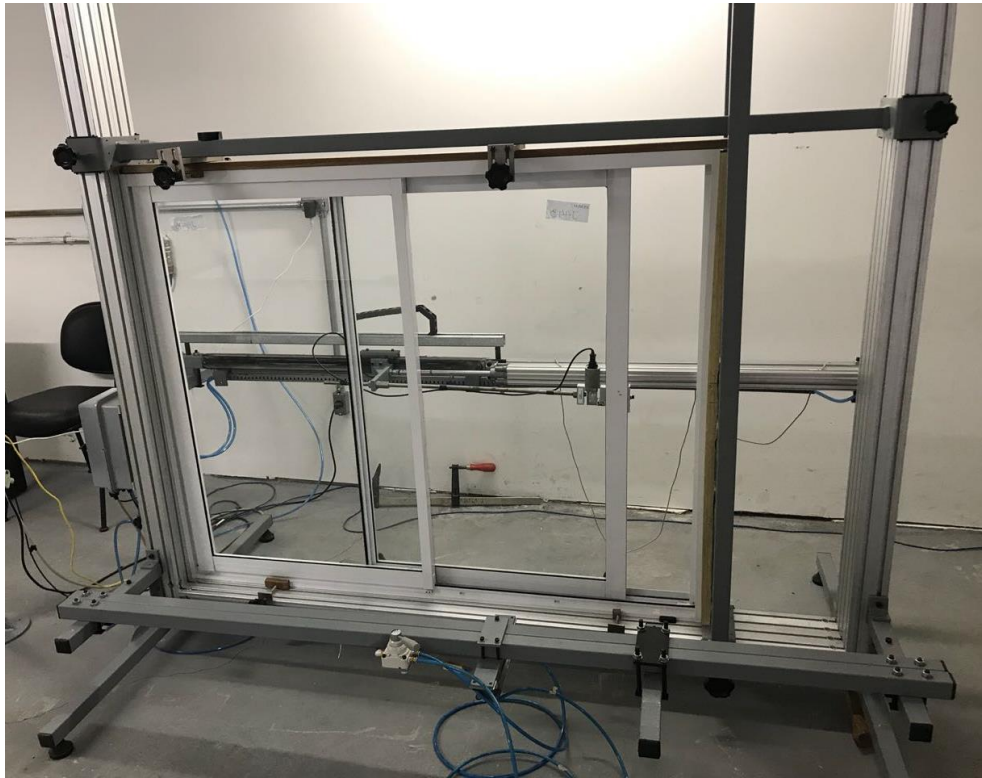
Figura 14 – Execução do Ensaio de Verificação do Comportamento Sob Ações Repetidas de Abertura e Fechamento
