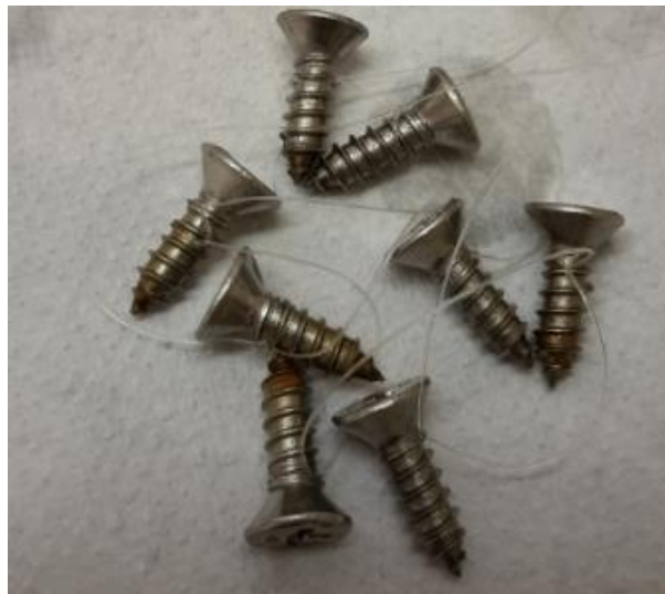
Figura 23 – Parafusos Submetidos ao Ensaio de Verificação da Resistência à Corrosão
