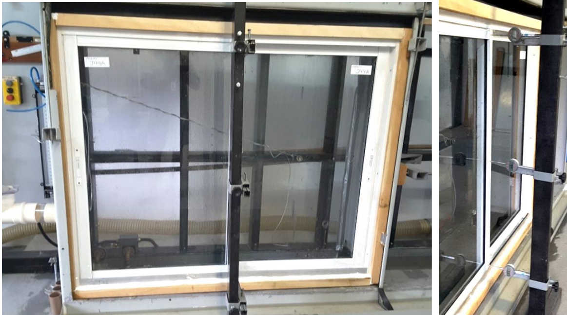
Figura 4 – Execução do Ensaio de Verificação do Comportamento Quando Submetido a Cargas Uniformemente Distribuídas
