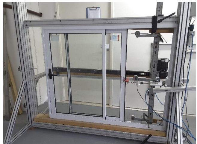
Figura 15 – Esquema de Posicionamento dos Relógios Comparadores (Esquerda) e Execução do Ensaio (Direita)
