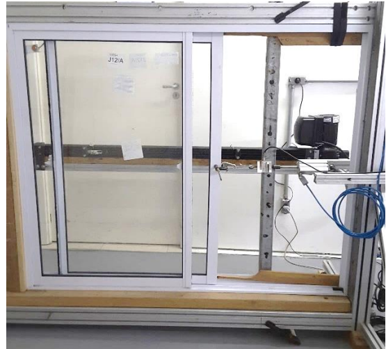
Figura 16 – Esquema do Ensaio Para Esquadrias de Correr (Esquerda) e Execução do Ensaio (Direita)
