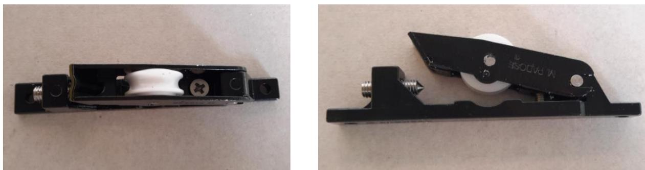
**Figura 21 – Roldanas Submetidas ao Ensaio de Verificação da Resistência à Corrosão**
