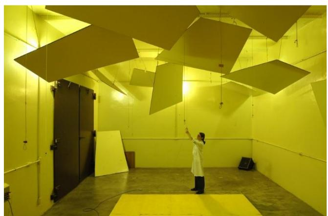
Figura 5 – Câmara de Ensaio de Isolação Sonora
