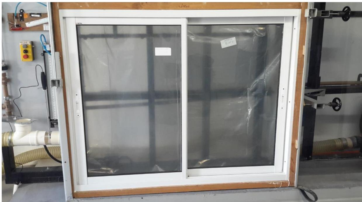
Figura 13 – Execução do Ensaio de Permeabilidade ao Ar
