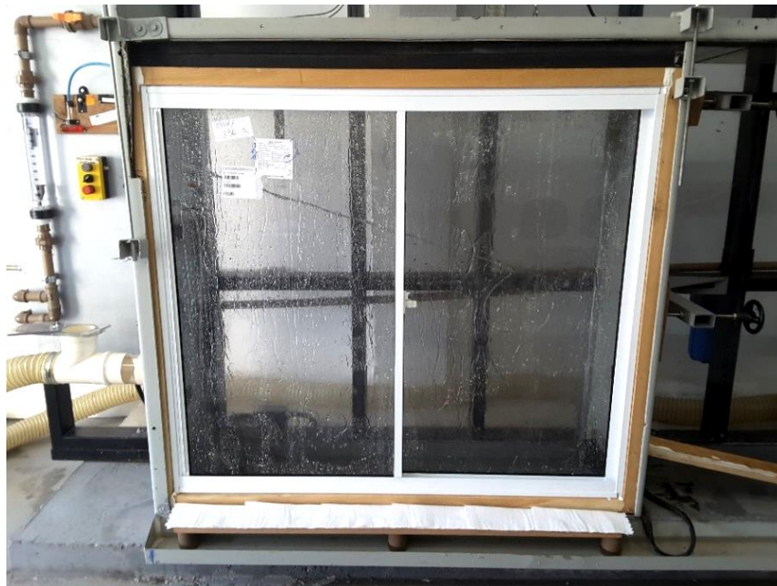
Figura 10 – Execução do Ensaio de Estanqueidade à Água
