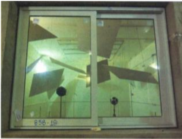
Figura 6 – Vista da Esquadria a Partir da Câmara de Emissão (Esquerda) e a Partir da Câmara de Recepção (Direita)
