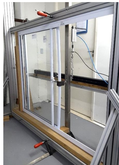
Figura 17 – Esquema do Ensaio Para Esquadrias de Correr (Esquerda) e Execução do Ensaio (Direita)
