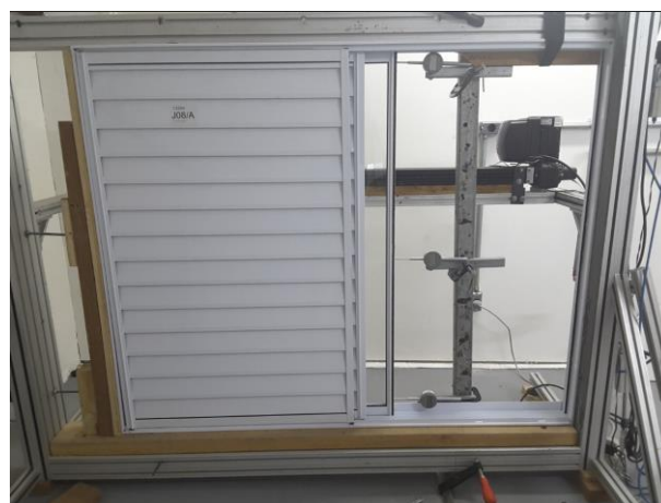
Figura 15 – Esquema de Posicionamento dos Relógios Comparadores (Esquerda) e Execução do Ensaio (Direita)
