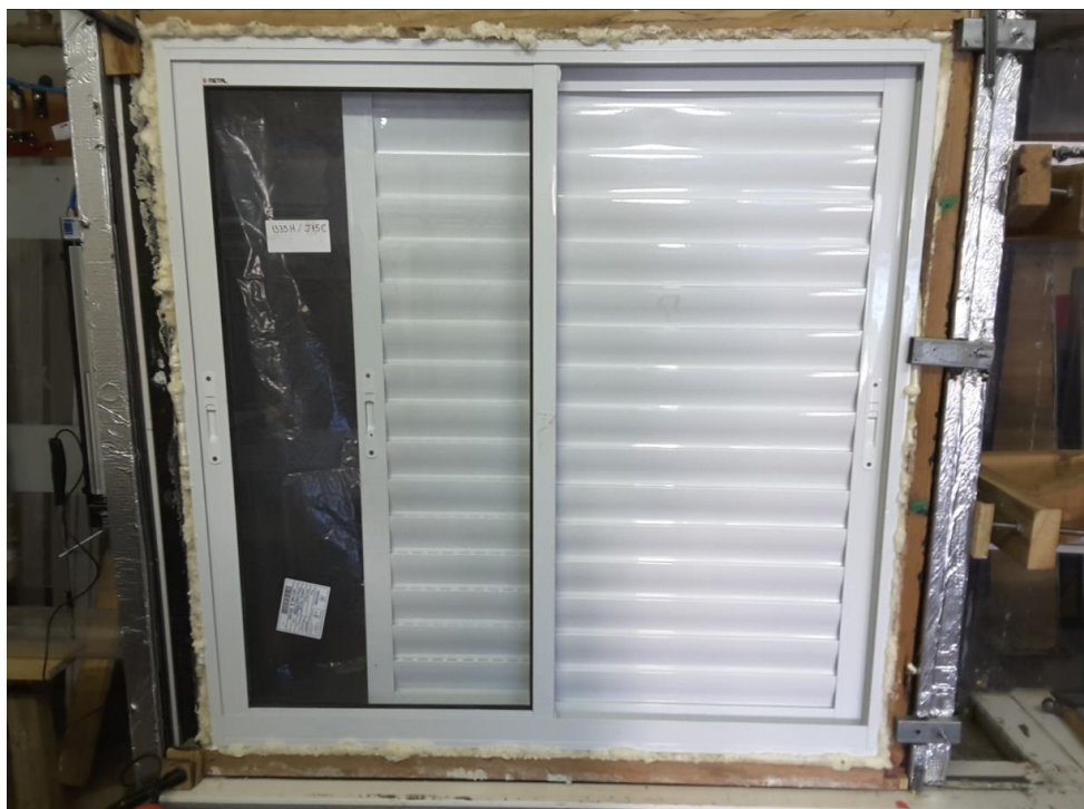
Figura 13 – Execução do Ensaio de Permeabilidade ao Ar
