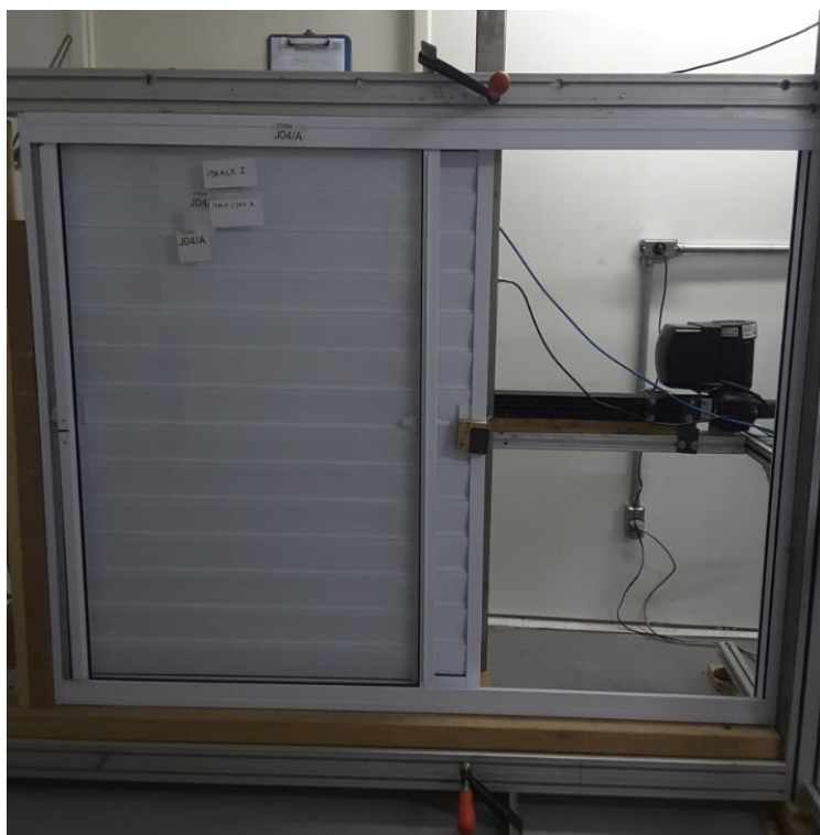
Figura 14 – Execução do Ensaio de Verificação do Comportamento Sob Ações Repetidas de Abertura e Fechamento
