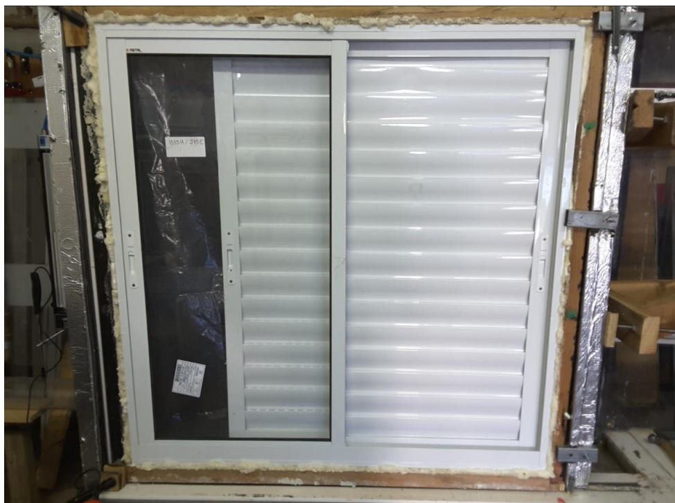
Figura 13 – Execução do Ensaio de Permeabilidade ao Ar
