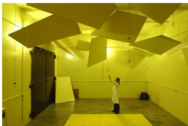
Figura 5 – Câmara de Ensaio de Isolação Sonora
