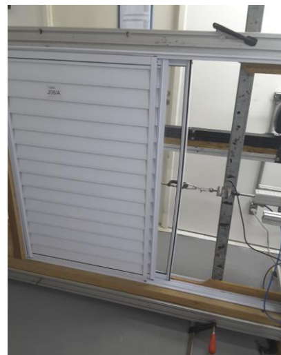
Figura 16 – Esquema do Ensaio Para Esquadrias de Correr (Esquerda) e Execução do Ensaio (Direita)
