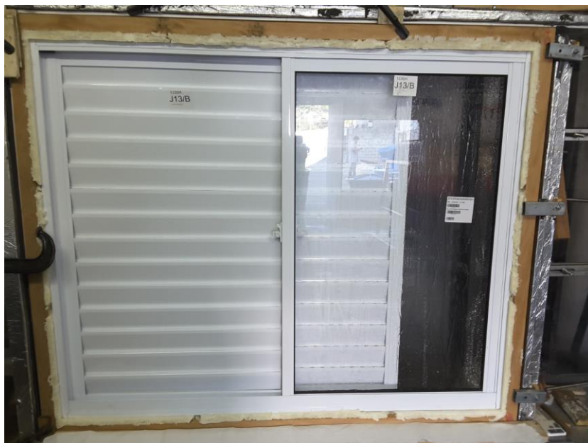
Figura 10 – Execução do Ensaio de Estanqueidade à Água
