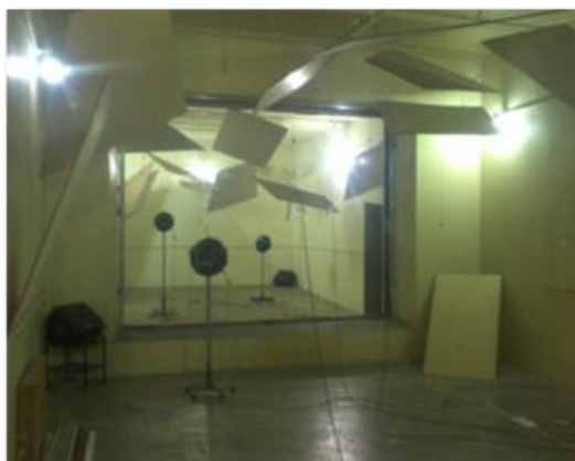
Figura 5 – Câmara de Ensaio de Isolação Sonora
