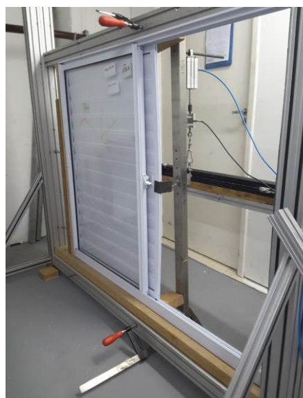
Figura 17 – Esquema do Ensaio Para Esquadrias de Correr (Esquerda) e Execução do Ensaio (Direita)
