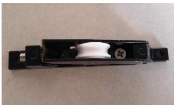
Figura 21 – Roldanas submetidas ao ensaio de verificação da resistência à corrosão
