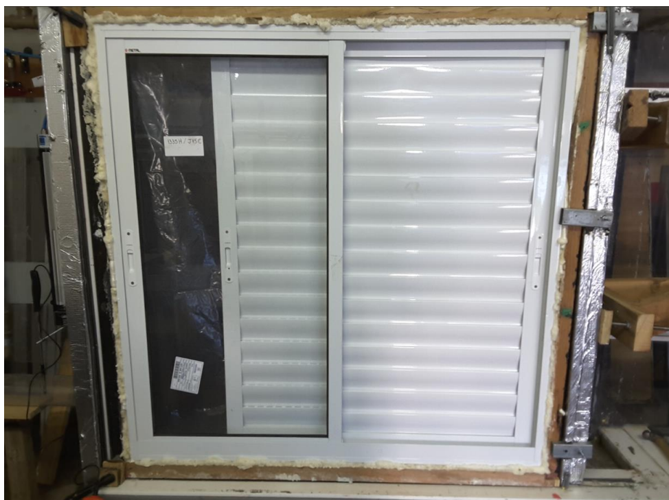
Figura 9 – Execução do ensaio de permeabilidade ao ar
