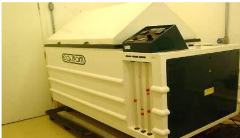
Figura 20 – Detalhe da câmara de névoa salina neutra onde soldas, fechos e parafusos são submetidos ao ensaio de verificação da resistência à corrosão
