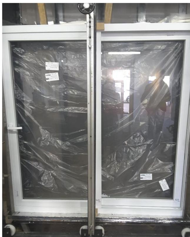
**Figura 9 – Execução do ensaio de permeabilidade ao ar**
