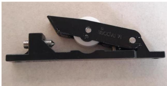
**Figura 23 – Roldanas submetidas ao ensaio de verificação da resistência à corrosão**
