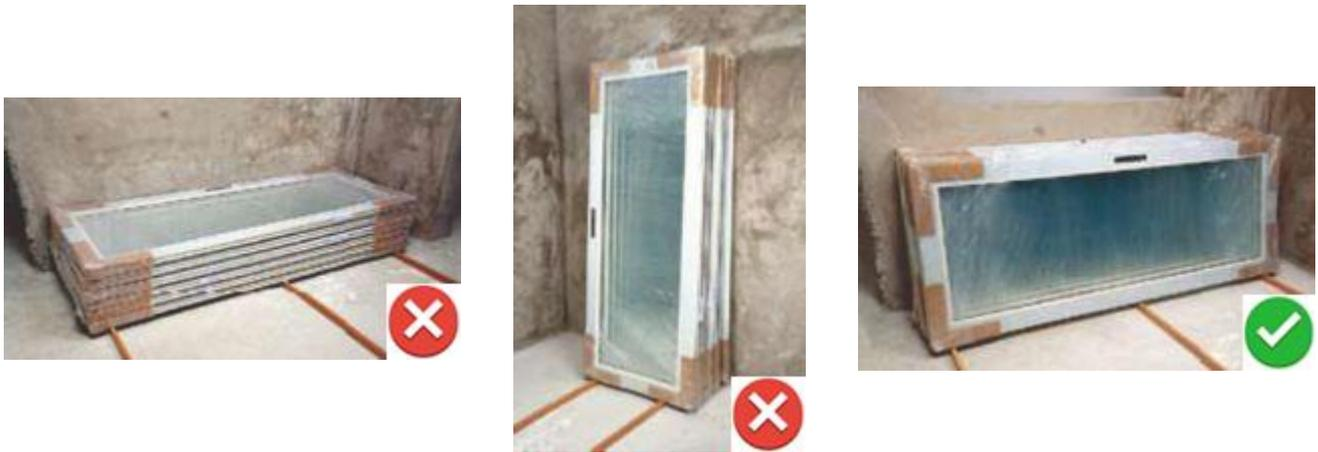
**Figura 25 – Armazenamento de folhas de esquadrias de correr de perfis em PVC rígido. Imagem cedida pela TIGRE LTDA.**
