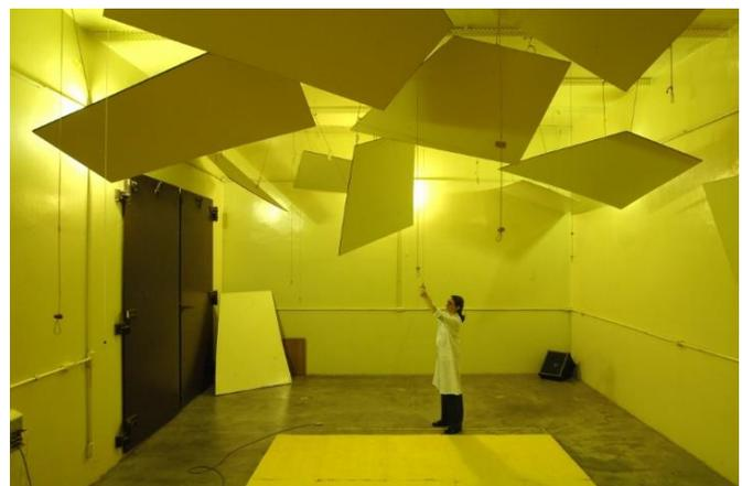
**Figura 13 – Câmara de ensaio de isolamento sonora**
