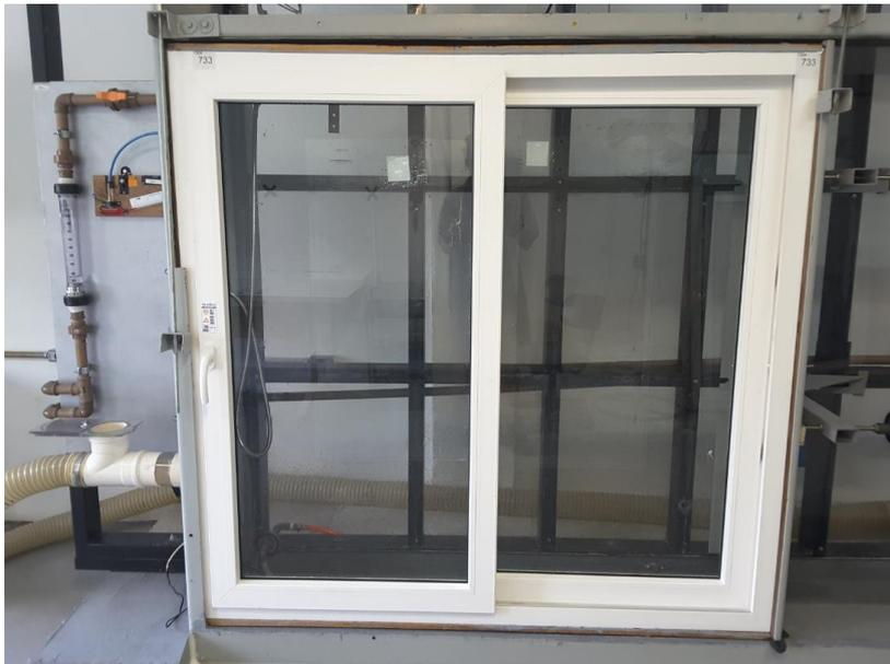
**Figura 10 – Execução do ensaio de estanqueidade à água**
