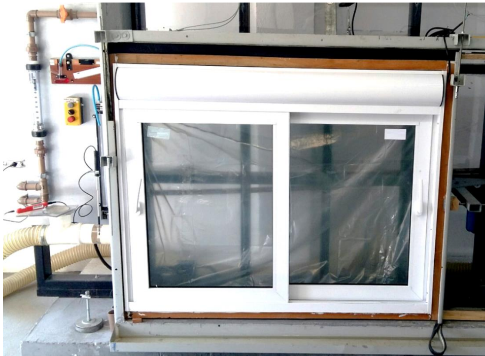
Figura 11 – Execução do ensaio de permeabilidade ao ar
