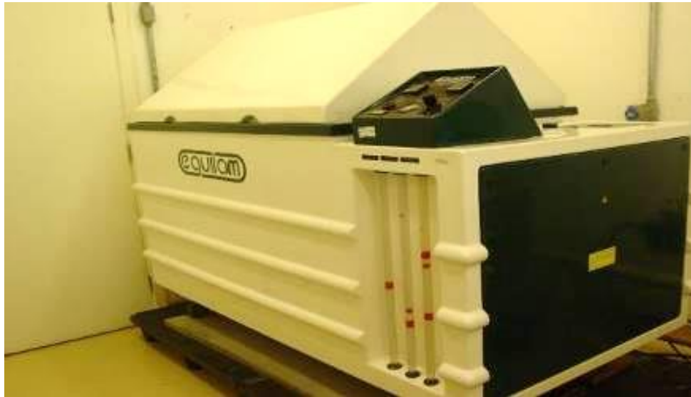
Figura 23 – Detalhe da câmara de névoa salina neutra onde roldanas e parafusos são submetidos ao ensaio de verificação da resistência à corrosão
