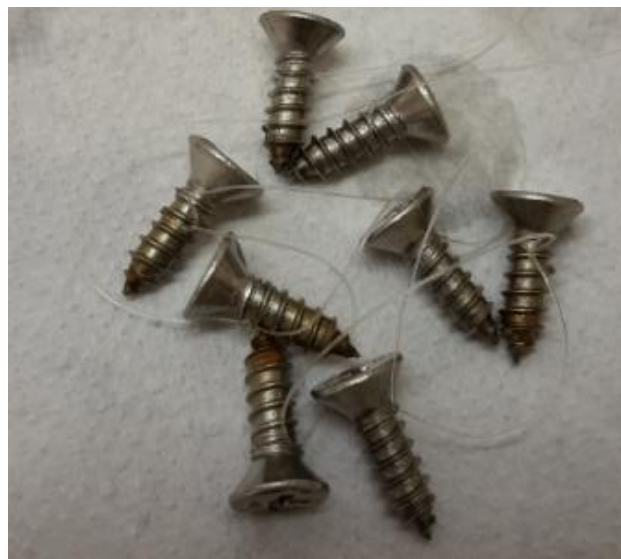
Figura 24 – Parafusos submetidos ao ensaio de verificação da resistência à corrosão
