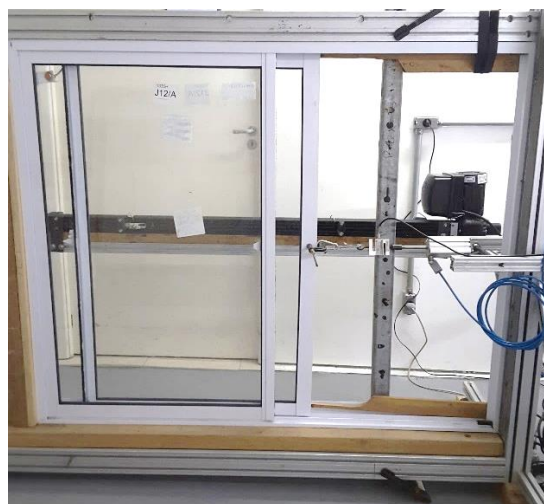
Figura 7 – Esquema do ensaio para esquadrias de correr (esquerda) e execução do ensaio (direita)
