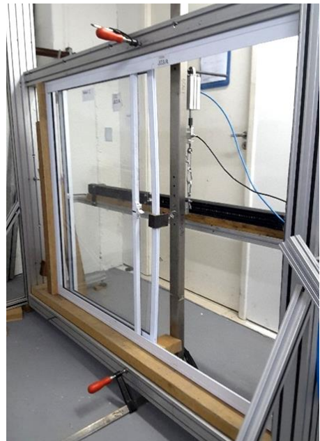
Figura 9 – Esquema do ensaio para esquadrias de correr (esquerda) e execução do ensaio (direita)
