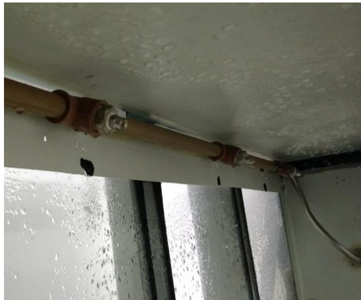
Figura 13 – Detalhe da aspensão do jato no ensaio de determinação da estanqueidade à água
