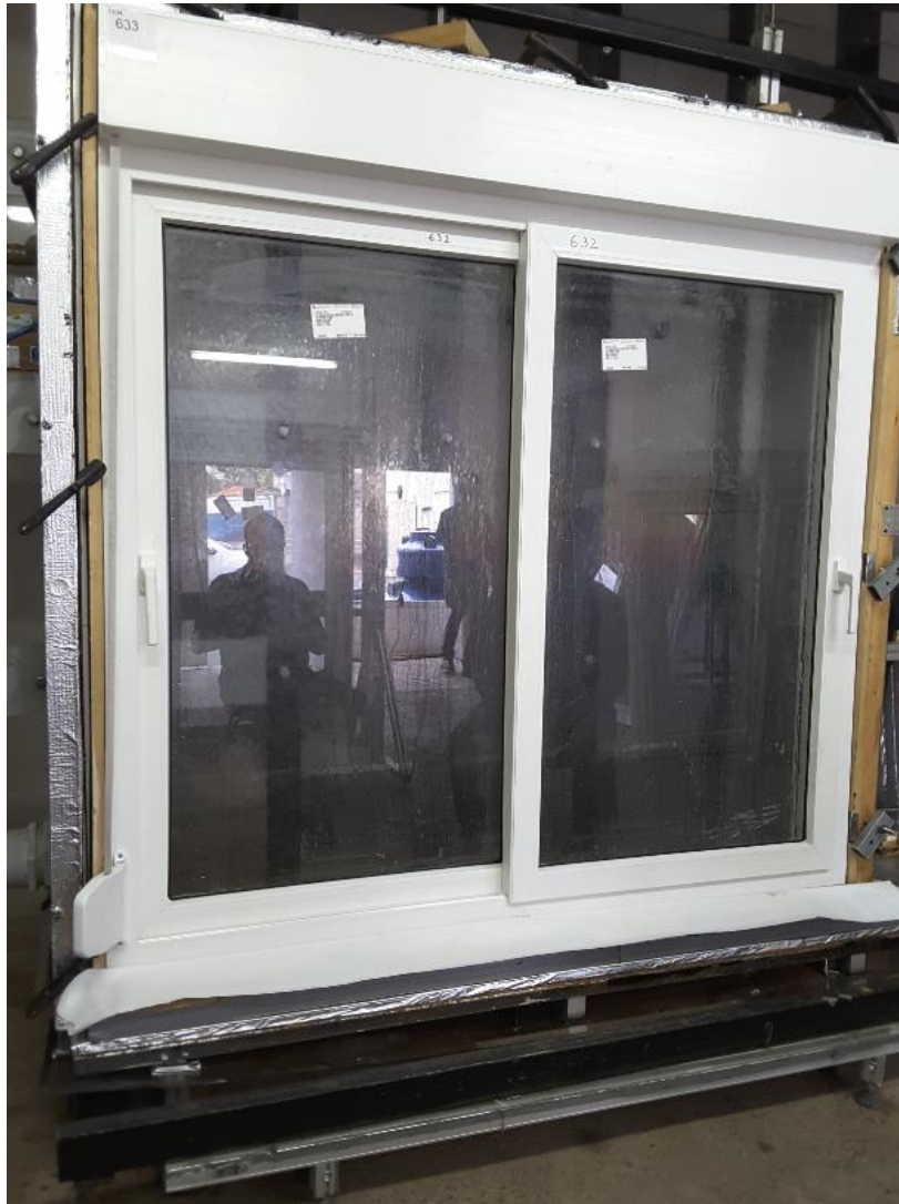
Figura 12 – Execução do ensaio de estanqueidade à água
