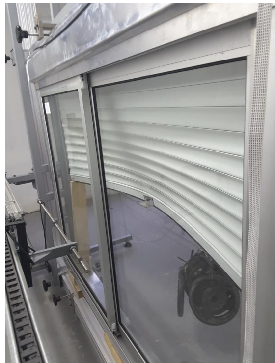
Figura 10 – Esquema do ensaio para esquadrias do tipo integrada – persiana de enrolar (esquerda) e execução do ensaio (direita)
