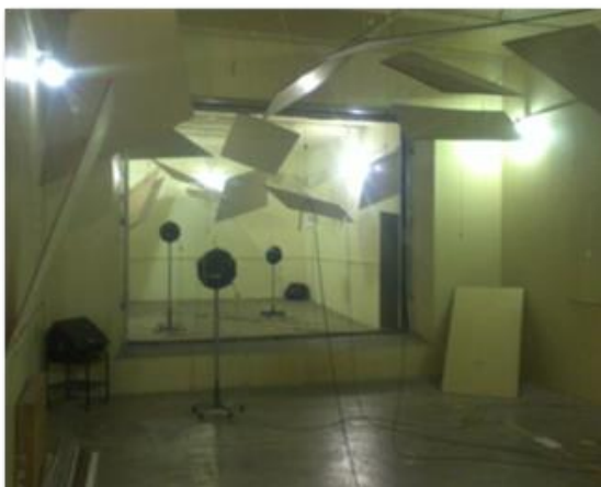
Figura 15 – Câmara de ensaio de isolamento sonora
