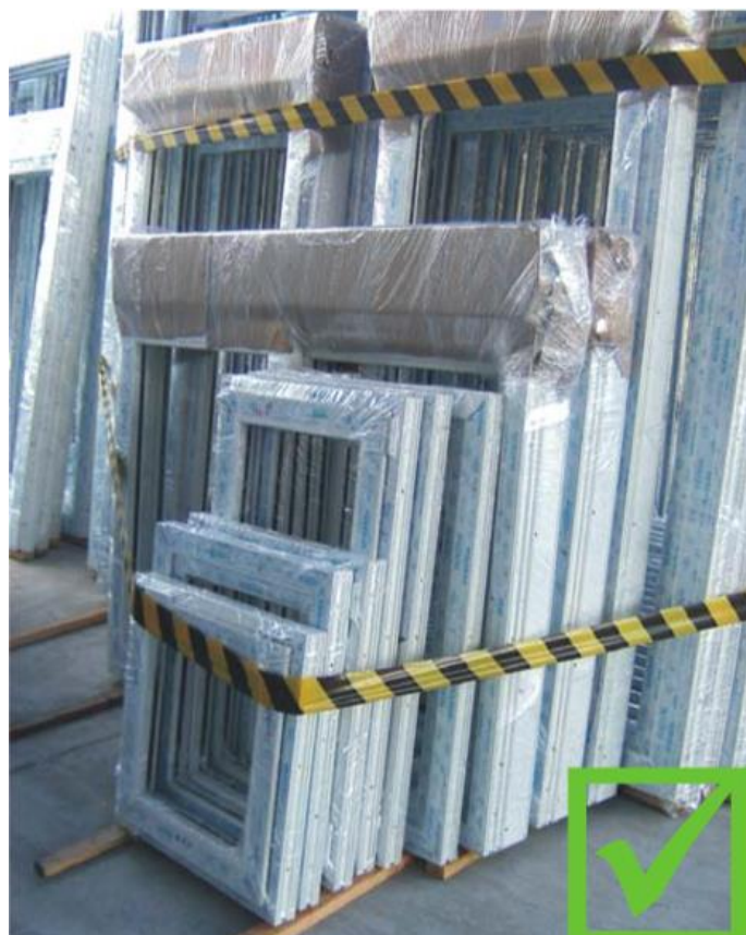
Figura 26 – Armazenamento de esquadrias de correr de perfis em PVC rígido. Imagem cedida pela WEIKU DO BRASIL
