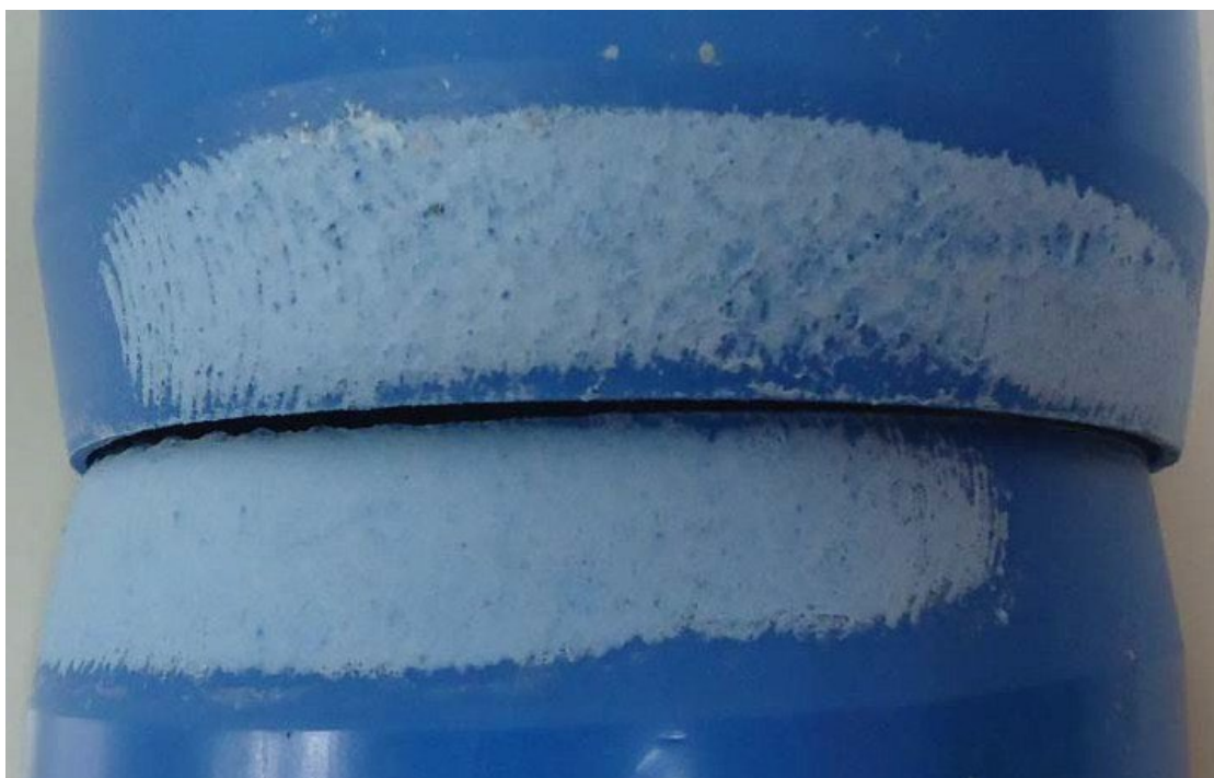
Figura 1 - Exemplo de grande ataque quanto ao requisito de resistência ao cloreto de metileno em tubos DEFOFO
