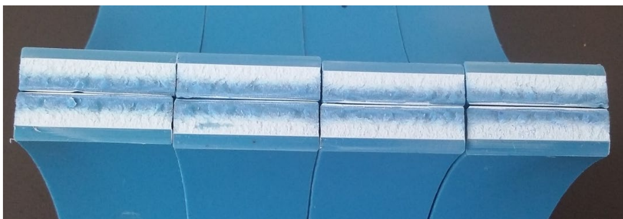
Figura 2 - Exemplo de ruptura dúctil-frágil nos quatro corpos de prova quanto ao requisito de resistência do anel C em tubos DEFOFO
