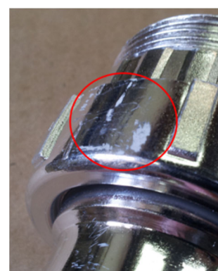
Falhas no revestimento
