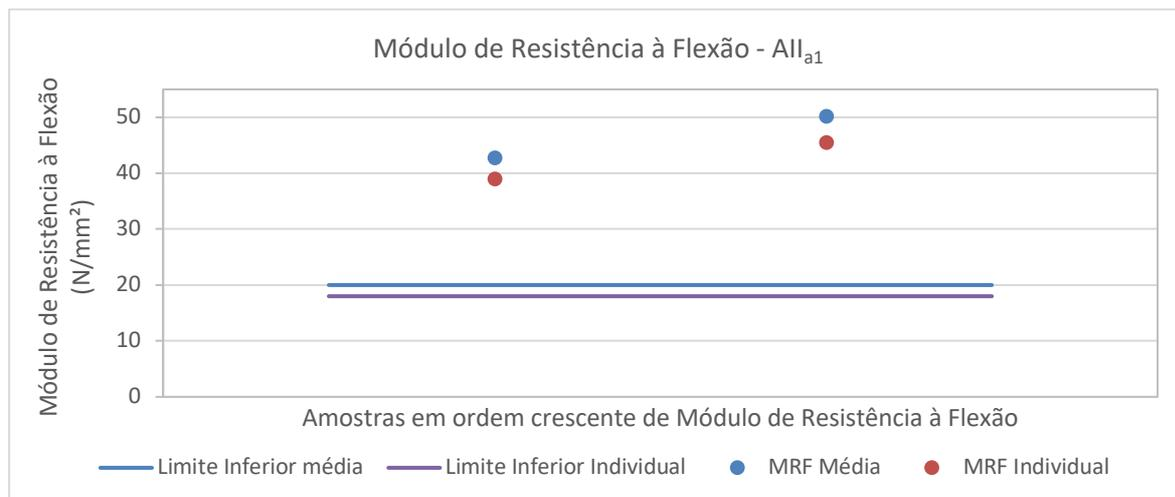
**Figura 24:** Valores médio e individual mínimo do módulo de resistência à flexão dos produtos do grupo de absorção de água AII<sub>a1</sub>.
