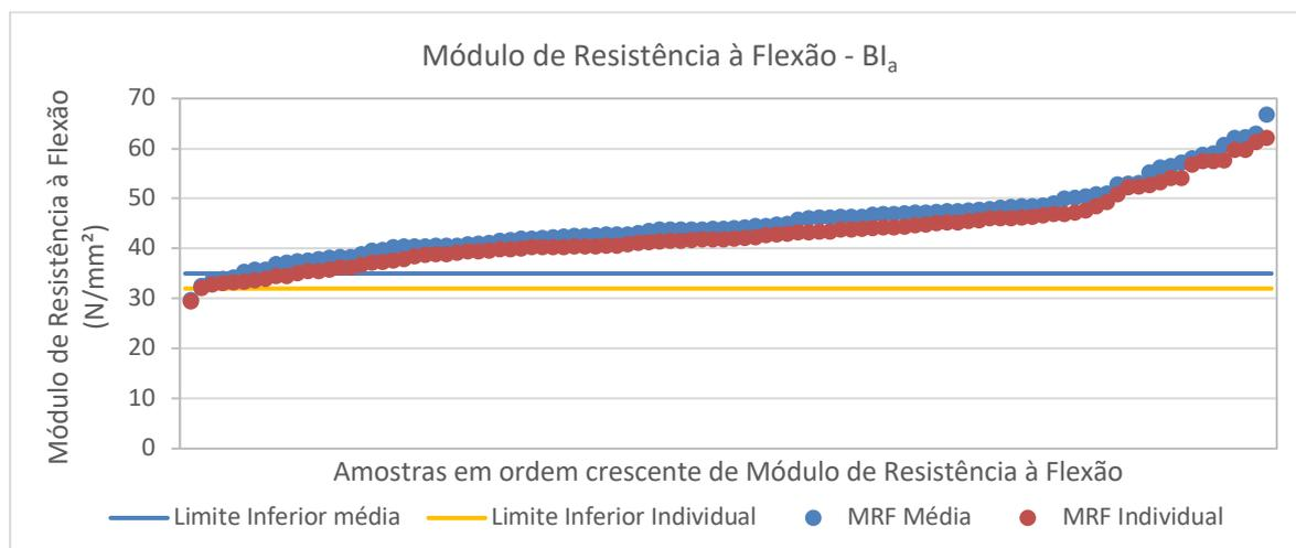
**Figura 25:** Valores médio e individual mínimo do módulo de resistência à flexão dos produtos do grupo de absorção de água BI<sub>a</sub>.
