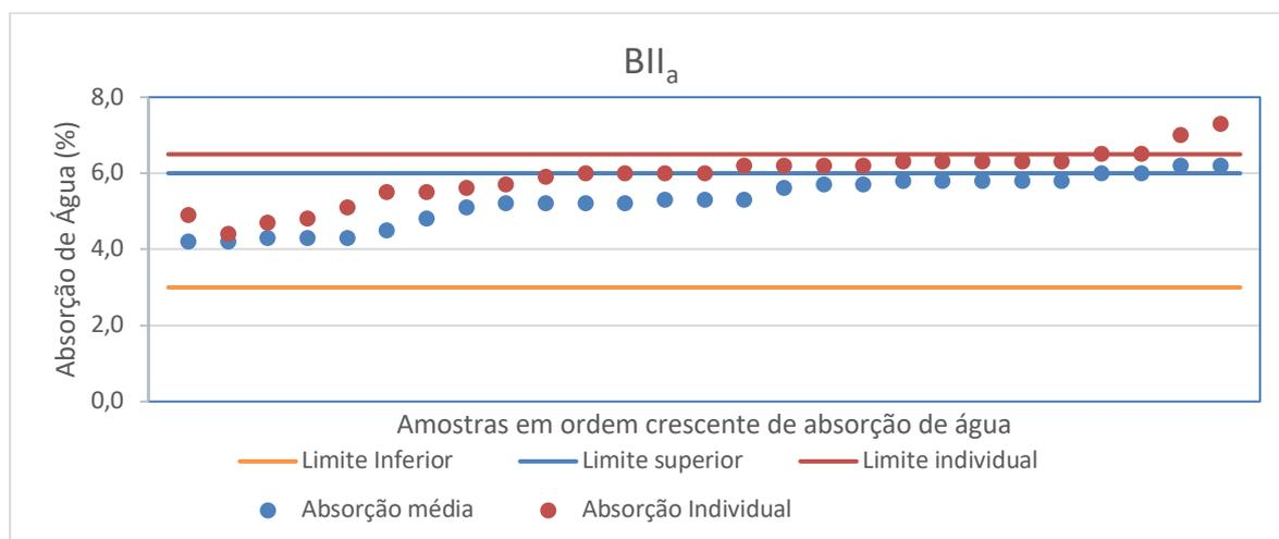
**Figura 13:** Valores médio e individual máximo de absorção de água para os produtos do grupo de absorção de água B11a.
