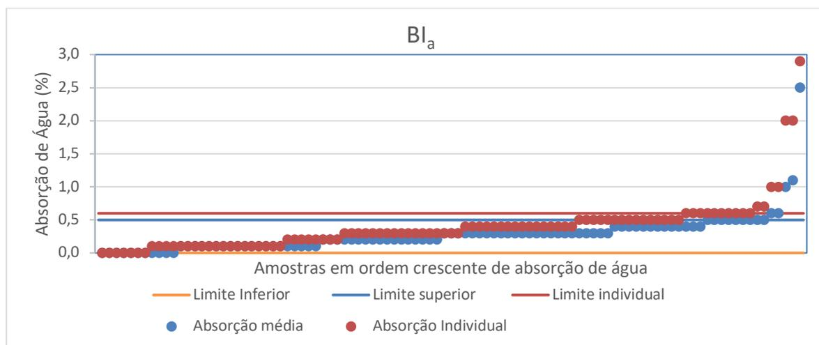
**Figura 11:** Valores médio e individual máximo de absorção de água para o produto do grupo de absorção de água  $B_{1a}$ .
