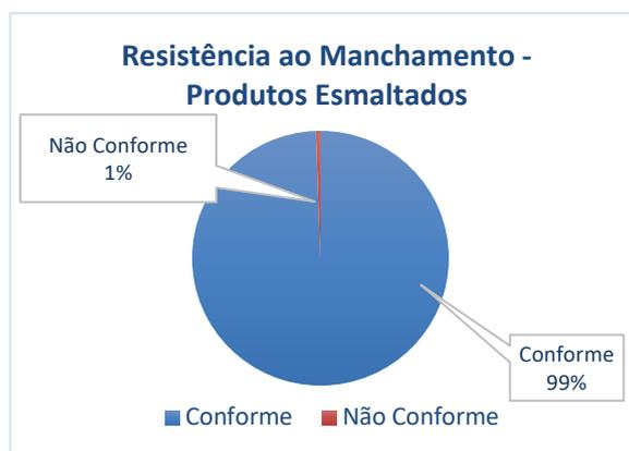
**Figura 31:** Resultados da determinação da resistência ao manchamento dos produtos esmaltados avaliados.
