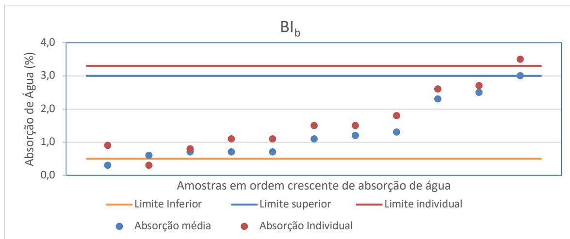
**Figura 12:** Valores médio e individual máximo de absorção de água para os produtos do grupo de absorção de água B1b.
