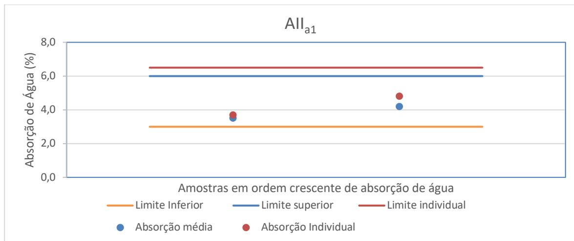
**Figura 10:** Valores médio e individual máximo de absorção de água para o produto do grupo de absorção de água  $AI_{a1}$ .
