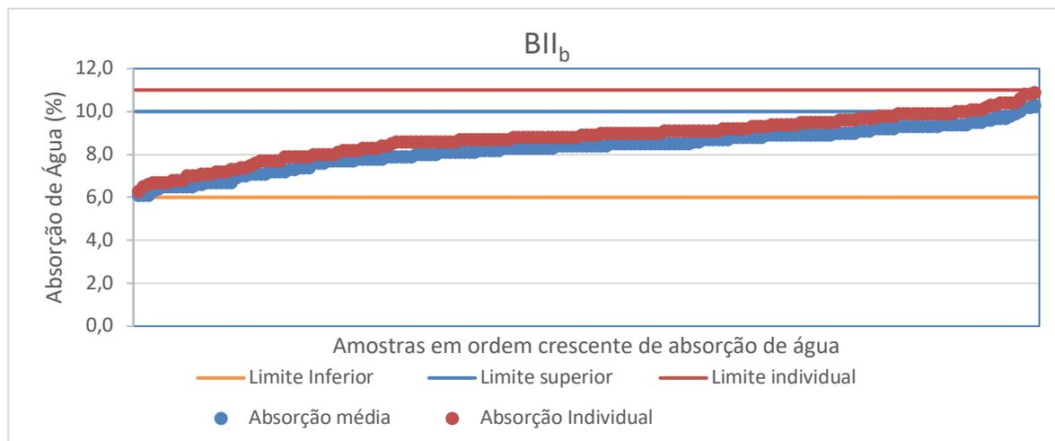
**Figura 14:** Valores médio e individual mínimo de absorção de água para os produtos do grupo de absorção de água BIIb.
