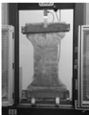
b. Ensaio de resistência à tração longitudinal
