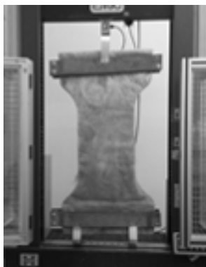
b. Ensaio de resistência à tração longitudinal
