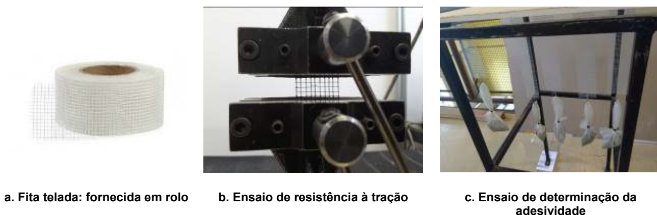
Figura 10 – Fita telada autoadesiva e exemplos de ensaios
