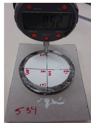
c. Ensaio de retração
