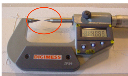
b. Micrômetro de ponta cônica (utilizado no ensaio de espessura)
