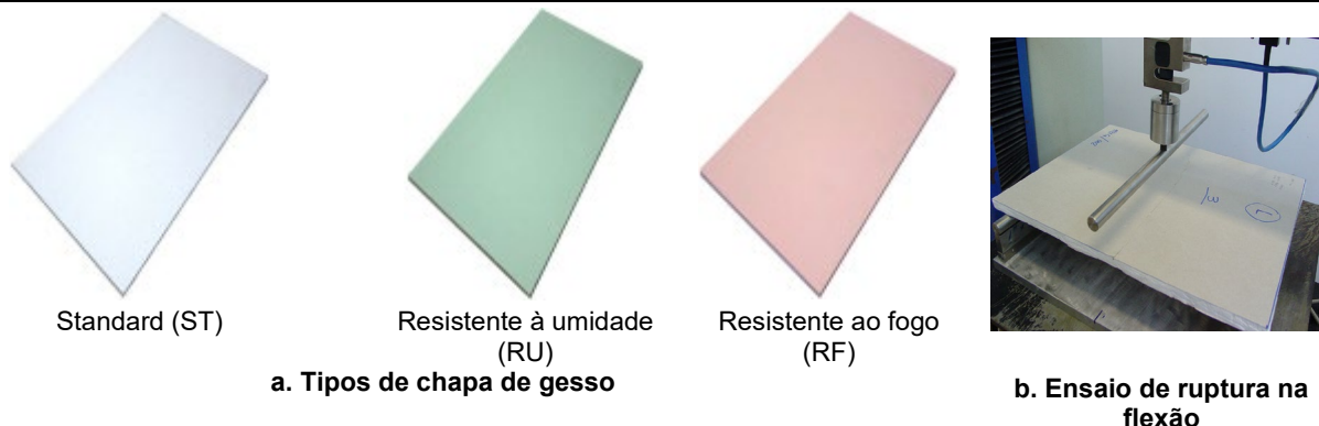
Figura 4 – Tipos de chapas de gesso e ensaio de ruptura à flexão
