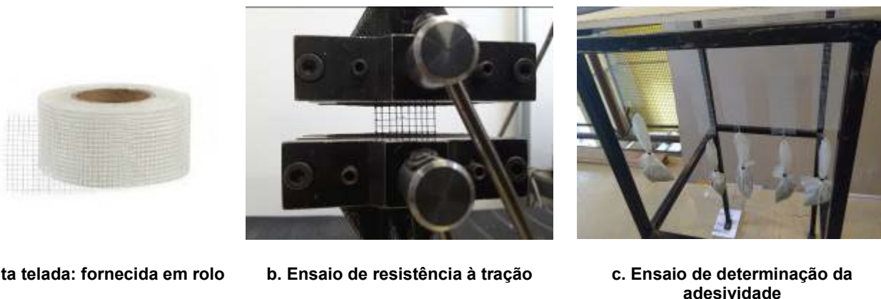
Figura 10 – Fita telada autoadesiva e exemplos de ensaios
