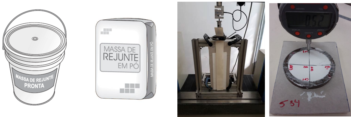
a. Tipos de massa para tratamento de juntas: pronta (fornecida em balde) e em pó (fornecida em saco) b. Ensaio de aderência da fita à massa c. Ensaio de retração
