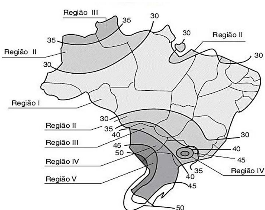
**Figura 2 – Gráfico das isopletas da velocidade básica do vento; “V<sub>0</sub>”, em m/s, no Brasil, conforme a ABNT NBR 6123**
