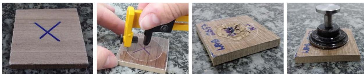
Figura 4 – Preparo dos Corpos de Prova.
