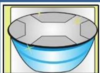
Limpar a parte interna da(s) tampa(s) do reservatório, fechar a tampa e verificar se a mesma está bem presa ao corpo do reservatório, apresentando a vedação esperada. Abrir novamente o registro e utilizar normalmente o reservatório. Coletar amostras da água para constatação da sua potabilidade.
