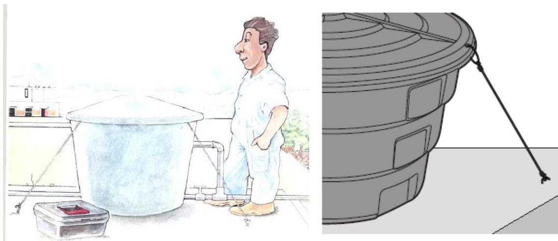
Figura 7 - Ilustração de fixação por meio de tirantes
