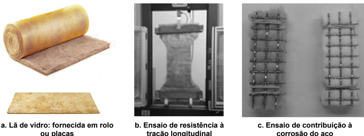
**Figura 8 – Tipos de lã de vidro e exemplos de ensaios**
