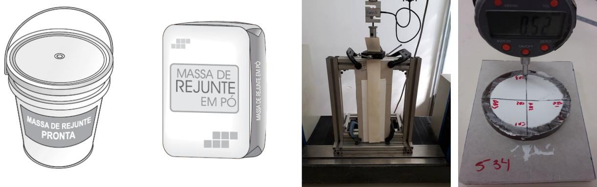
**a. Tipos de massa para tratamento de juntas: pronta (fornecida em balde) e em pó (fornecida em saco)**      **b. Ensaio de aderência da fita à massa**      **c. Ensaio de retração**
