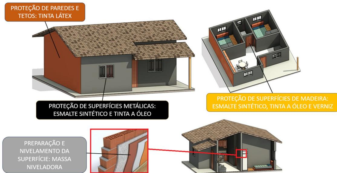
**Figura 1** – Aplicação tintas imobiliárias avaliadas pelo Programa Setorial na construção civil.
