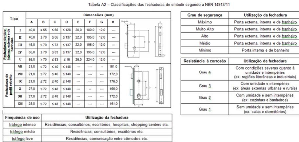
**Figura 5** – Tabela A.2 do Relatório Setorial do Programa Setorial de Fechadura, com as classificações e padrões dimensionais das fechaduras de embutir, segundo a NBR 14913/11
