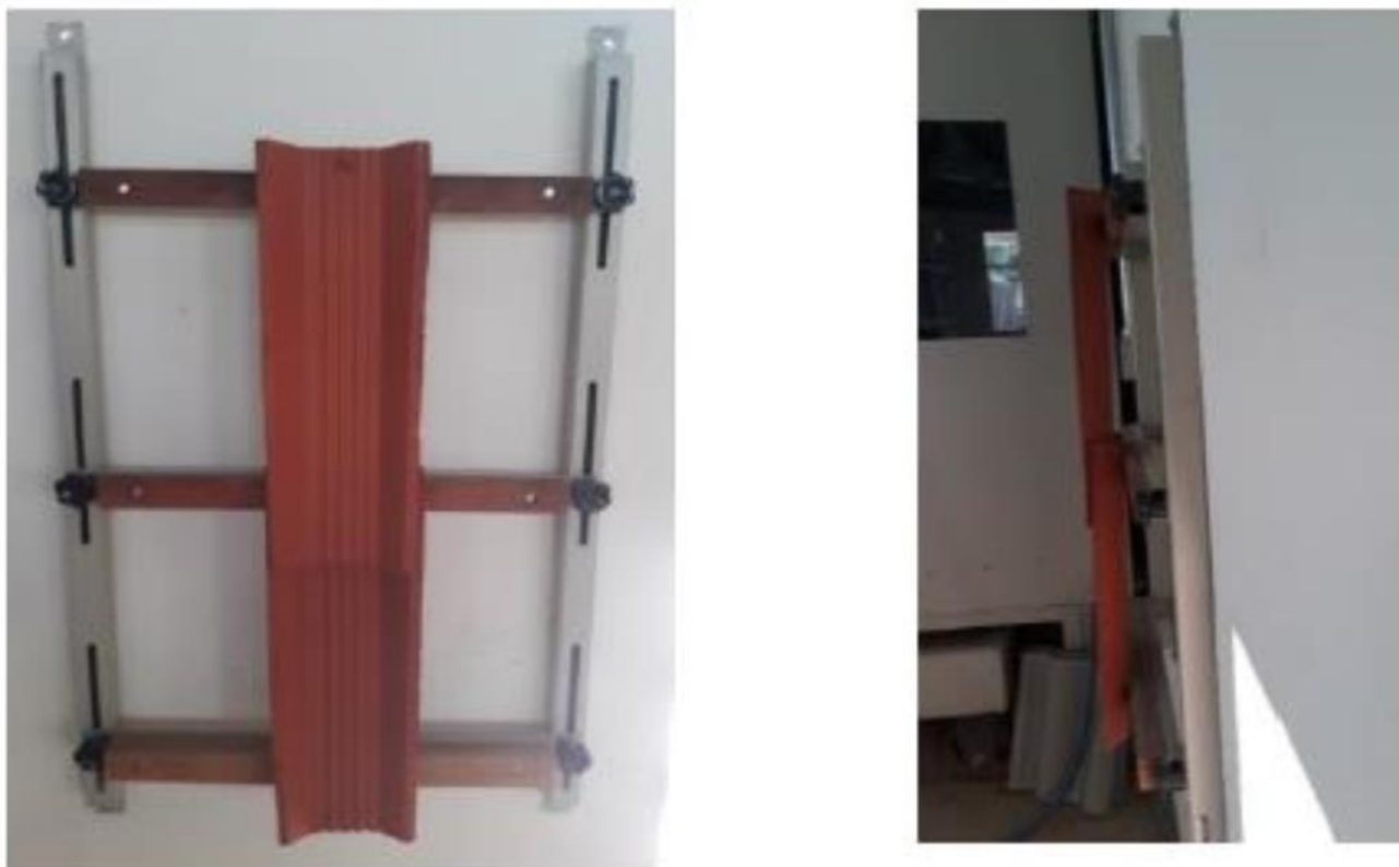
Figura 11 - Instrumentação requerida ao ensaio de fixação de garra (Relatório de ensaio CCB N°03513-19)
