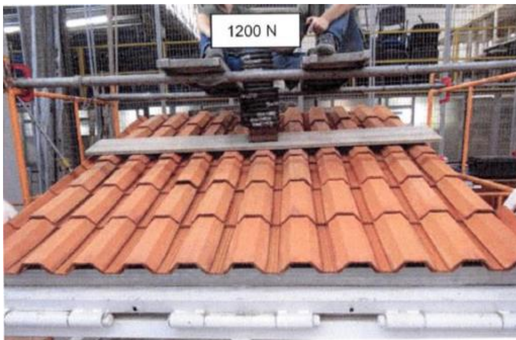
Figura 13 – Execução do ensaio de caminhamento (Relatório de ensaio Unisinos Nº2787-2019)
