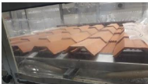
Figura 9 - Execução de ensaio de estanqueidade à água (Relatório de ensaio CCB N°03513-19)
