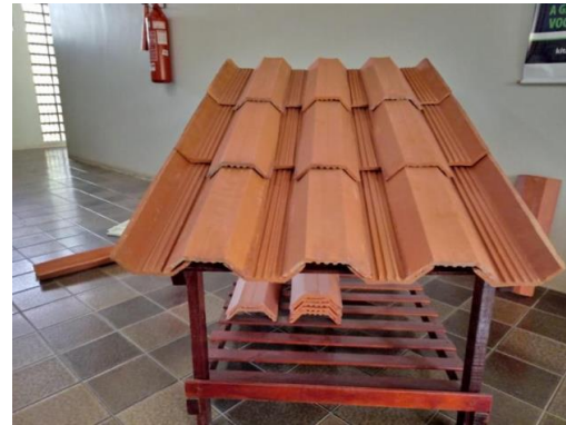
Figura 7 - Finalização da montagem das telhas
