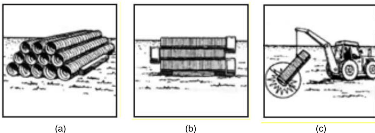
**Figura 13 – Armazenamento dos tubos no canteiro de obras (figura extraída do Manual de Bolso para instalações de tubulações corrugadas Tigre-ADS).**
