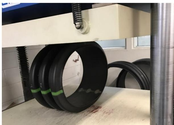
*Figura 18 – Ensaio de rigidez anelar.*
