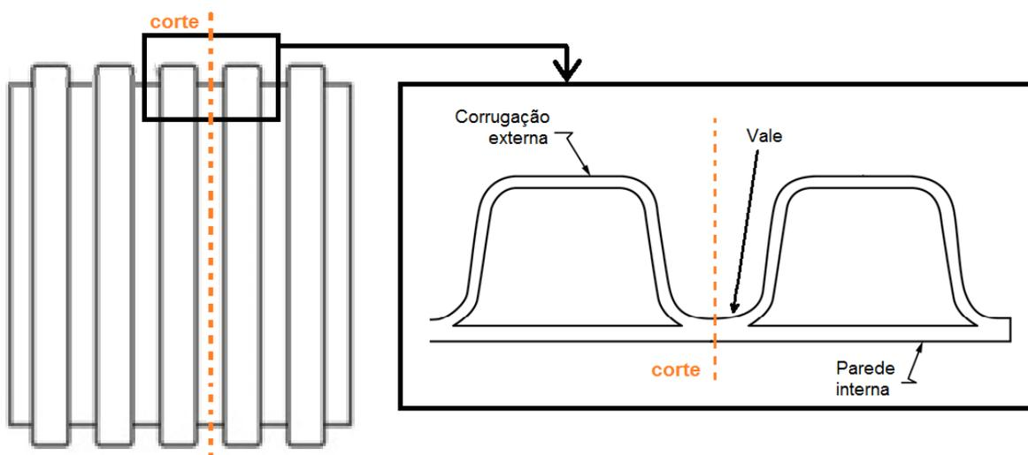
**Figura 14 – Região onde deve ser executado o corte da tubulação**
