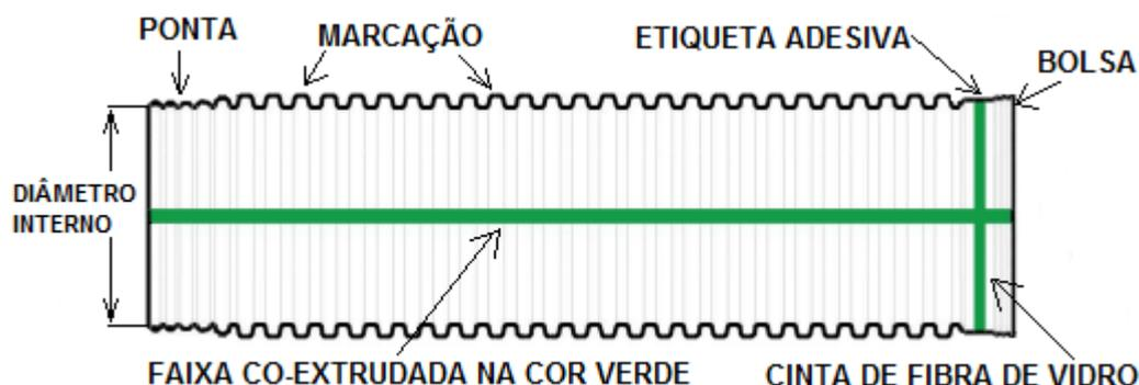
**Figura 6 – Tubo corrugado de polietileno alvo deste DATec – desenho típico.**
