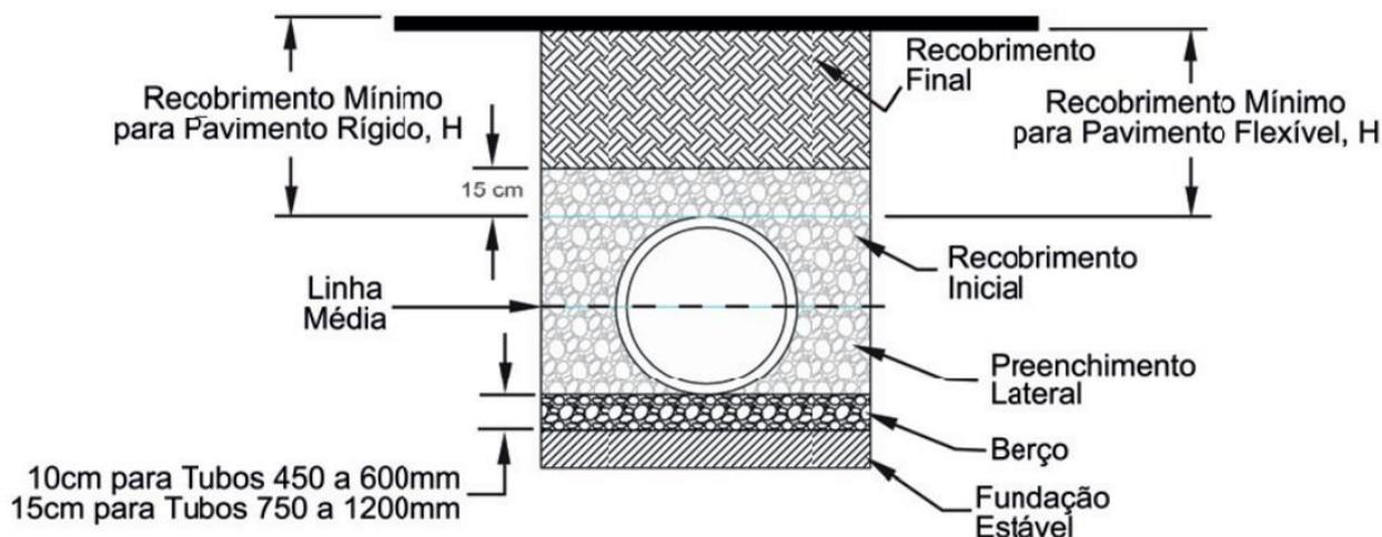
**Figura 17 – Seção da vala (figura extraída do Manual de Bolso para instalações de tubulações corrugadas Tigre-ADS).**
