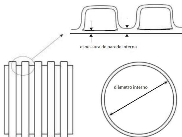
Figura 9 – Espessura da parede interna e diâmetro interno.
