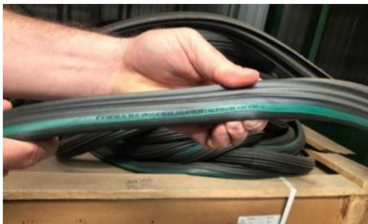
**Figura 10 – Anel de vedação utilizado nas uniões entre os tubos.**
