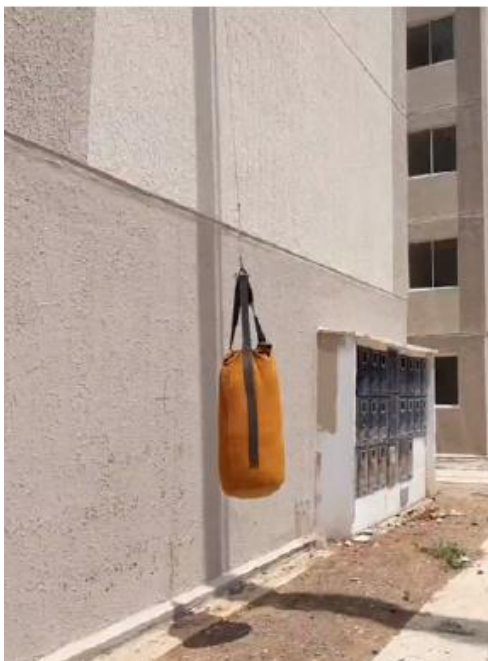
Figura 6 - Corpo mole utilizado para impacto no sistema vertical
