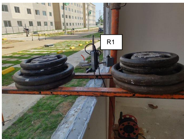
Figura 9 – Condições da amostra durante o carregamento vertical
