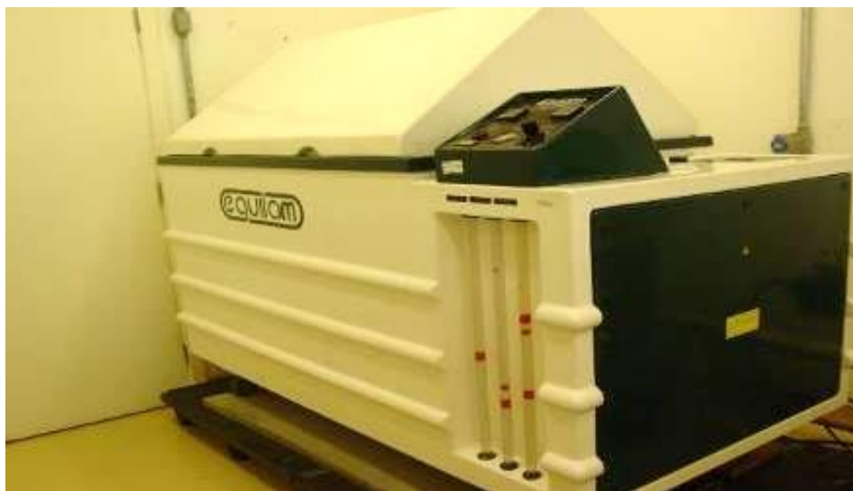
Figura 20 – Detalhe da Câmara de Névoa Salina Neutra Onde Roldanas, Fechos e Parafusos São Submetidos ao Ensaio de Verificação da Resistência à Corrosão
