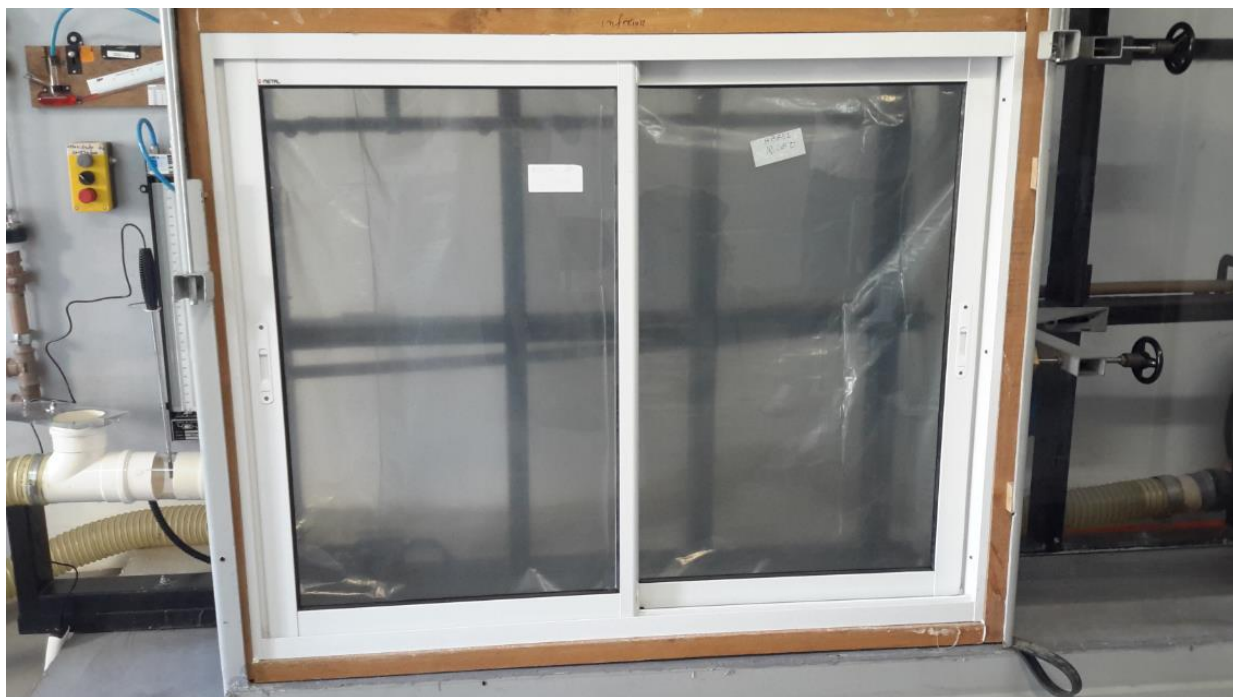
Figura 13 – Execução do Ensaio de Permeabilidade ao Ar
