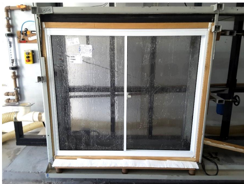
Figura 10 – Execução do Ensaio de Estanqueidade à Água
