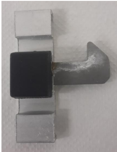
Figura 22 – Fecho Submetido ao Ensaio de Verificação da Resistência à Corrosão
