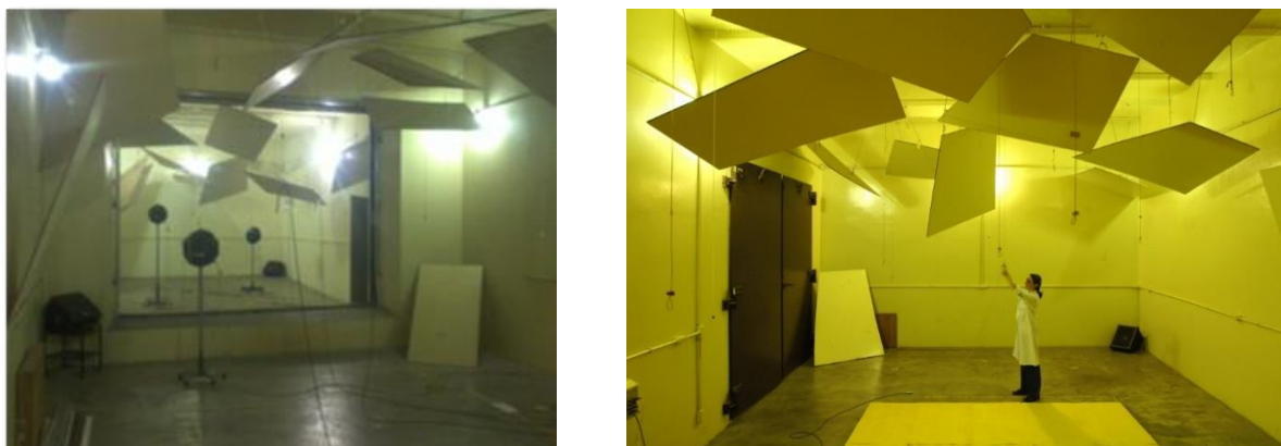
Figura 5 – Câmara de Ensaio de Isolação Sonora
