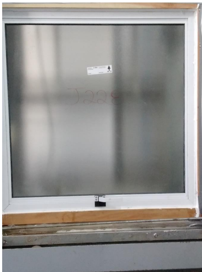
Figura 13 – Execução do Ensaio de Permeabilidade ao Ar
