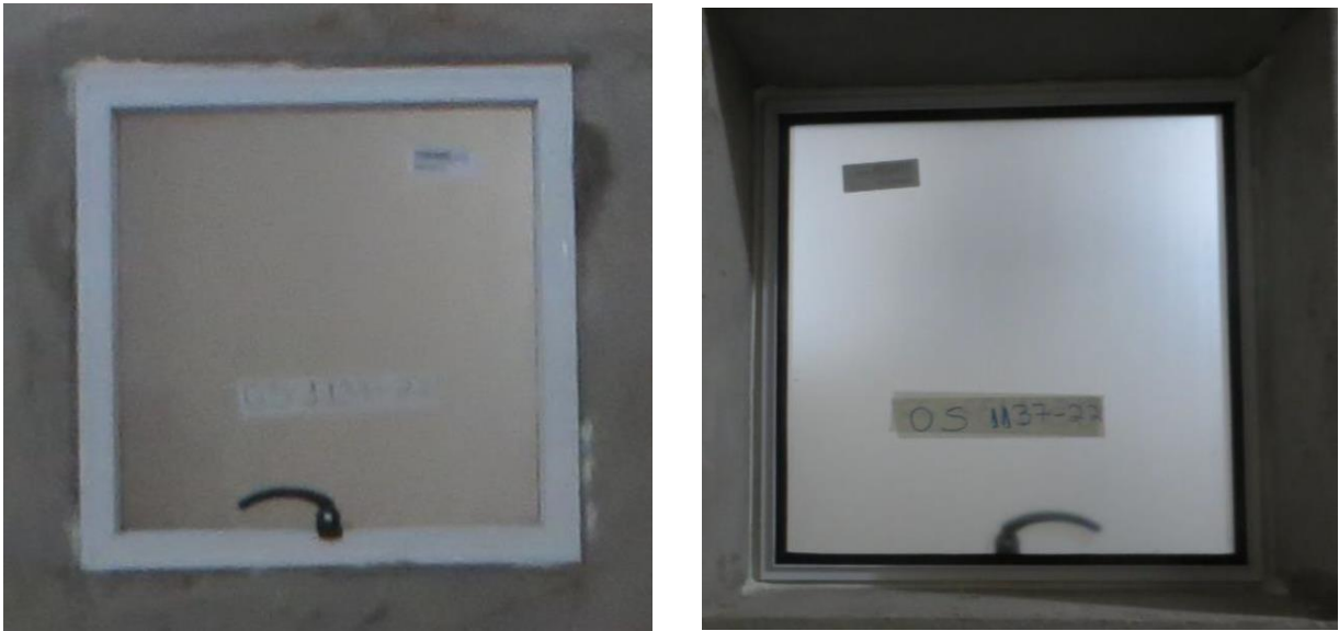
Figura 6 – Vista da Esquadria a Partir da Câmara de Emissão (Esquerda) e a Partir da Câmara de Recepção (Direita)
