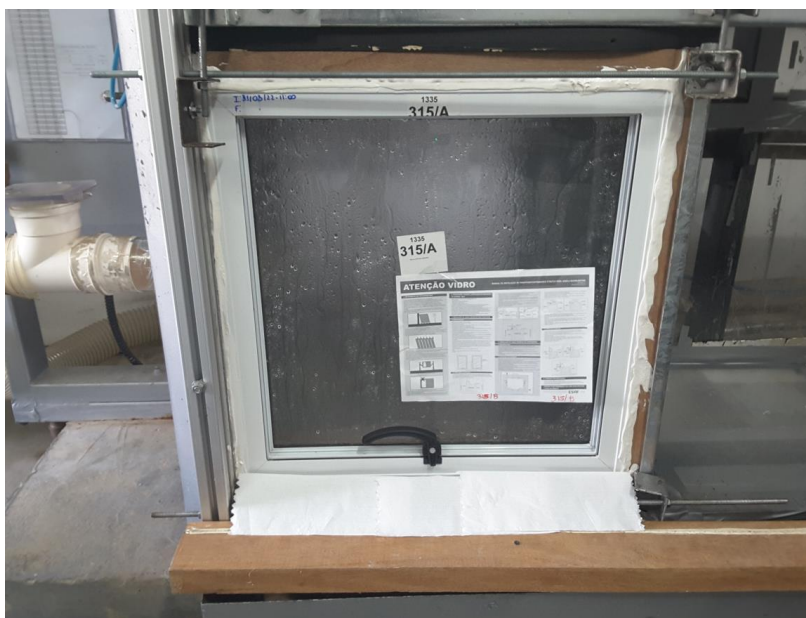
Figura 10 – Execução do Ensaio de Estanqueidade à Água
