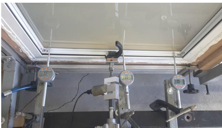
Figura 15 – Esquema de Posicionamento dos Relógios Comparadores (Esquerda) e Execução do Ensaio (Direita)
