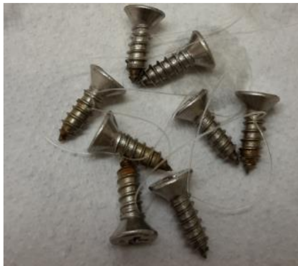
Figura 22 – Parafusos Submetidos ao Ensaio de Verificação da Resistência à Corrosão
