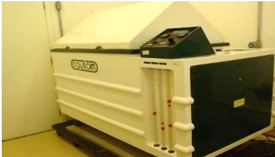
Figura 20 – Detalhe da Câmara de Névoa Salina Neutra Onde Fechos e Parafusos São Submetidos ao Ensaio de Verificação da Resistência à Corrosão
