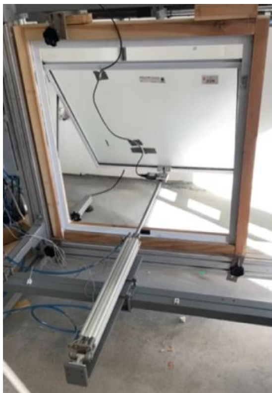
Figura 14 – Execução do Ensaio de Verificação do Comportamento Sob Ações Repetidas de Abertura e Fechamento
