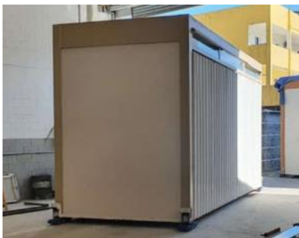
a) Módulo pré-fabricado ainda fechado – parte central em perfis de aço
