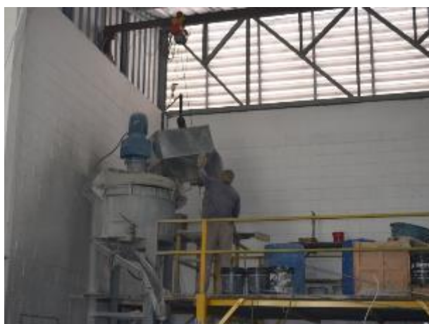
Figura 15 – Mistura dos materiais para a produção da chapa cimentícia.
