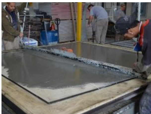
Figura 17 – Retirada do excesso e nivelamento da massa.
