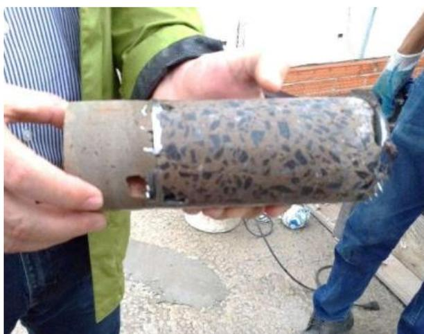
**Figura 42** – Testemunho extraído na inspeção técnica
