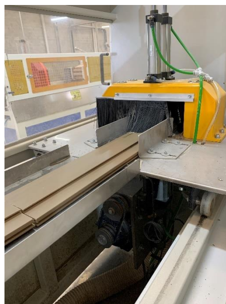
Figura 7 – Corte do perfil de “PVC Wood” no comprimento especificado.
