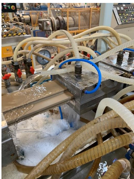
Figura 6 – Extrusão do perfil de “PVC Wood”, seguida de resfriamento com jatos d’água.
