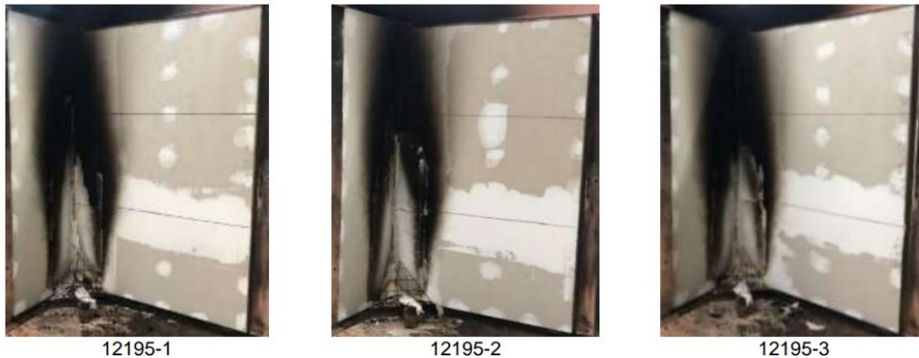
Figura 6 – Corpos de prova do sistema após do ensaio de SBI
