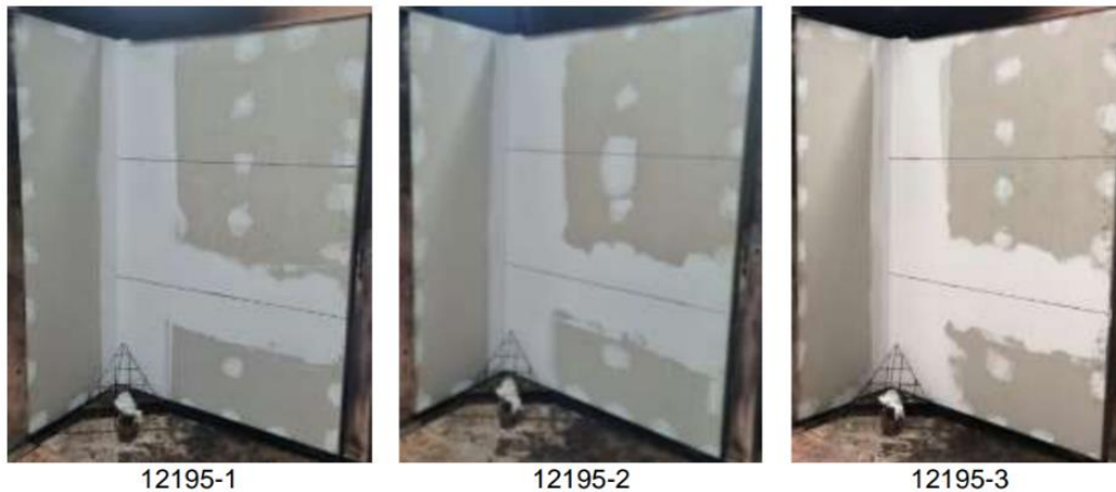
Figura 5 – Corpos de prova do sistema antes do ensaio de SBI
