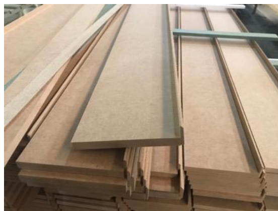
Figura 10 – Alizares conformados por painéis de MDF e HDF.
