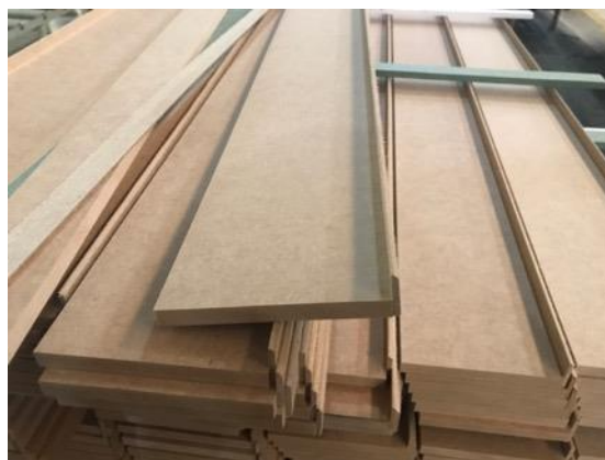
Figura 10 – Alizares conformados por painéis de MDF e HDF.
