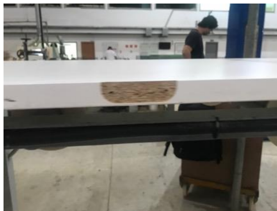
Figura 07 – Usinagem da folha de porta.
