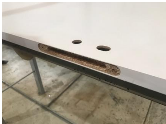
Figura 07 – Usinagem da folha de porta.
