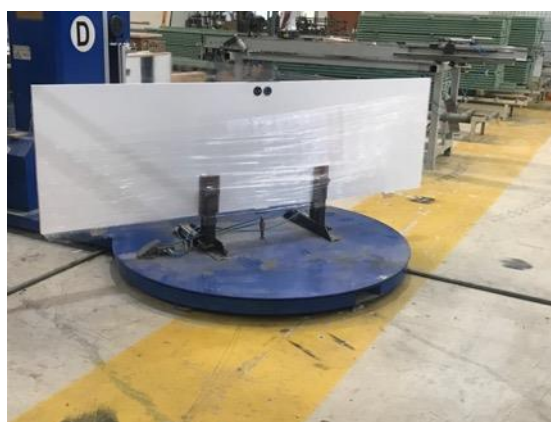
Figura 08 – Instalação das ferragens na folha de porta e proteção com filme plástico.
