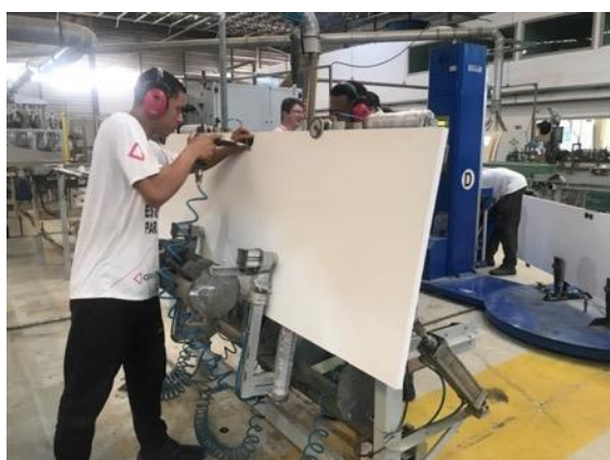
Figura 08 – Instalação das ferragens na folha de porta e proteção com filme plástico.
