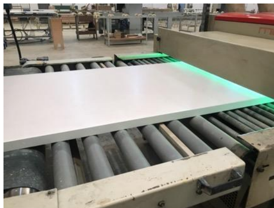
Figura 06 – Linha de pintura das folhas de porta.
