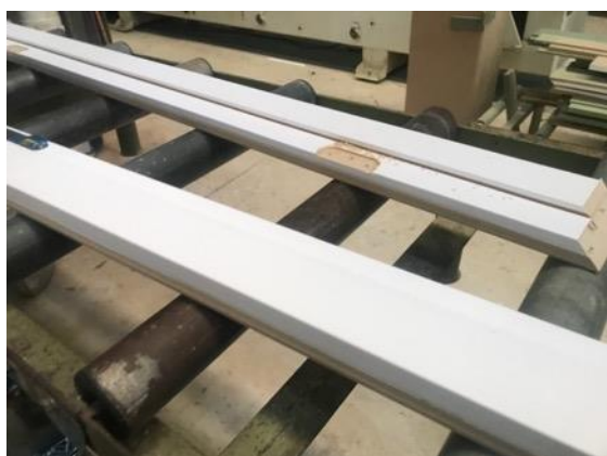
Figura 11– Detalhe da fixação da contratesta no marco após usinagem.
