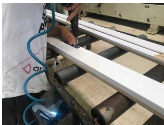
Figura 11– Detalhe da fixação da contratesta no marco após usinagem.
