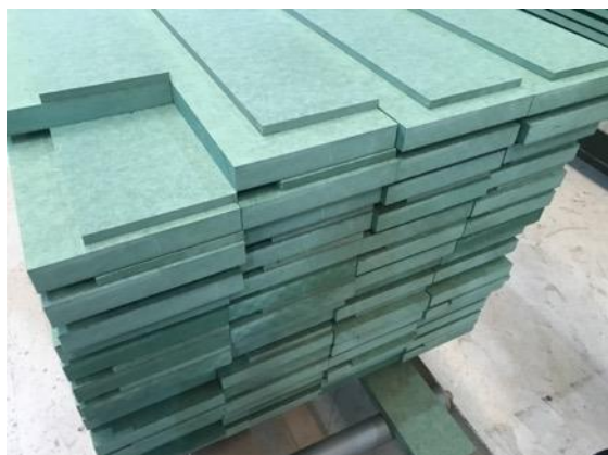
Figura 09 – Marcos conformados por painéis de MDF.
