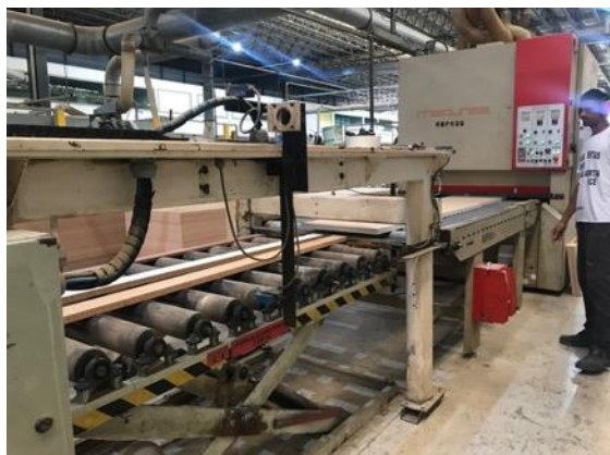
Figura 06 – Linha de pintura das folhas de porta.
