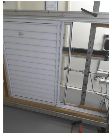
Figura 16 – Esquema do Ensaio Para Esquadrias de Correr (Esquerda) e Execução do Ensaio (Direita)
