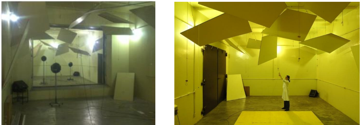
Figura 5 – Câmara de Ensaio de Isolação Sonora
