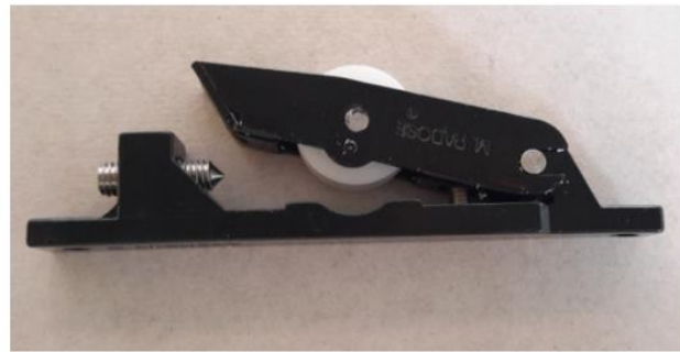
Figura 21 – Roldanas Submetidas ao Ensaio de Verificação da Resistência à Corrosão
