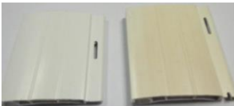
Figura 24 – Perfil em PVC rígido padrão (esquerda) e após exposição em câmara de weather-o-meter (direita)
