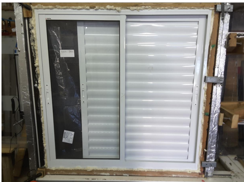
Figura 13 – Execução do Ensaio de Permeabilidade ao Ar
