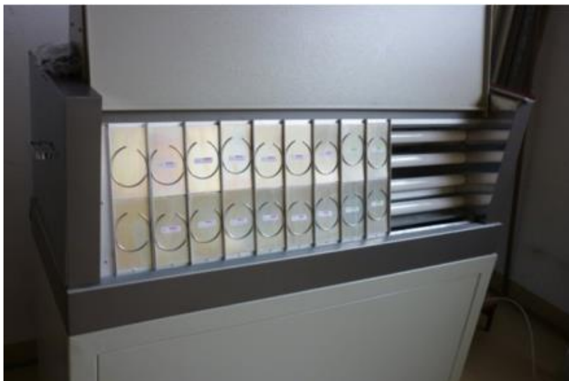
Figura 25 – Câmara de UV para avaliação da durabilidade do composto de PVC
