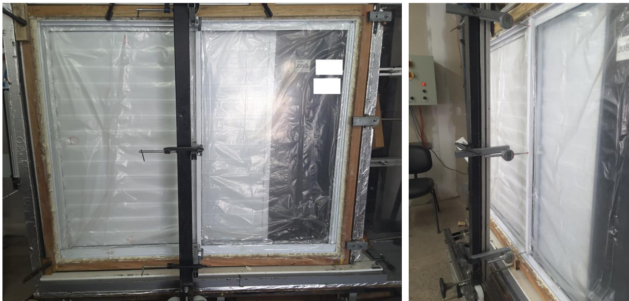
Figura 4 – Execução do Ensaio de Verificação do Comportamento Quando Submetido a Cargas Uniformemente Distribuídas
