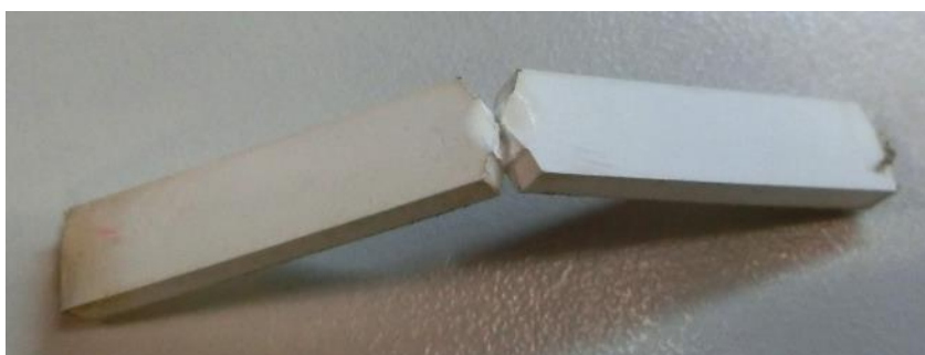
Figura 26 – Corpo de prova submetido ao ensaio de verificação da resistência ao impacto Charpy após exposição em câmara de UV
