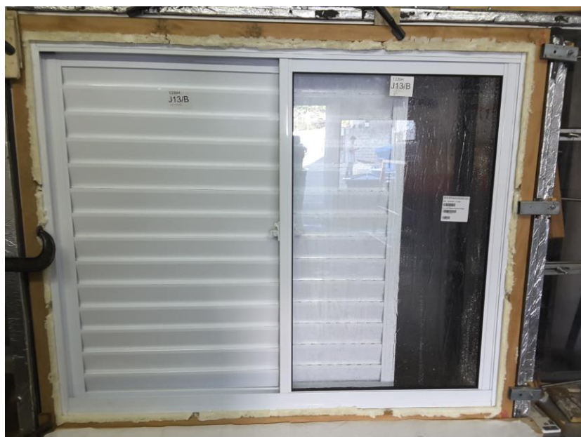
Figura 10 – Execução do Ensaio de Estanqueidade à Água
